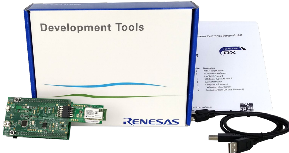
図 3 : クラウドオプションボードと Pmod Wi-Fi モジュールを備えた Renesas RX65N クラウドキット (出展 : Renesas Electronics Corp.)
