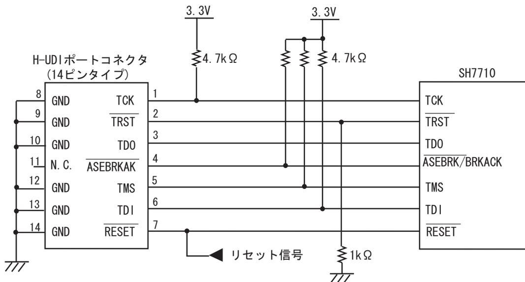
図 1.7 E10A 使用時の H-UDI ポートコネクタ - チップ間の推奨接続例(14 ピンタイプ)
