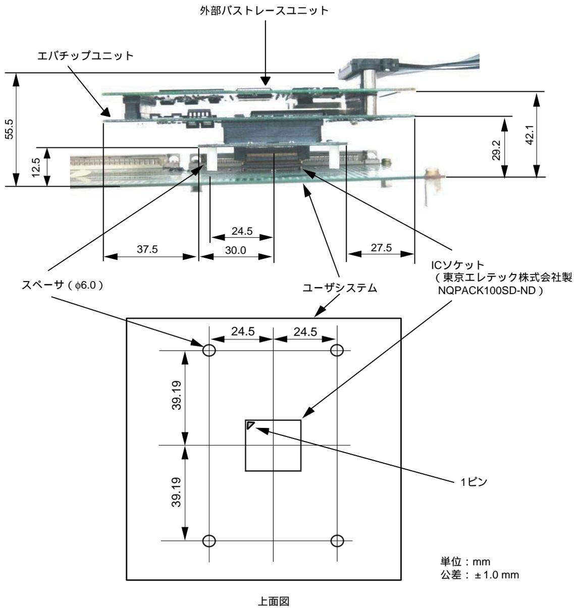
図9 ユーザーシステムインターフェイスボード接続時のユーザーシステムとの寸法
