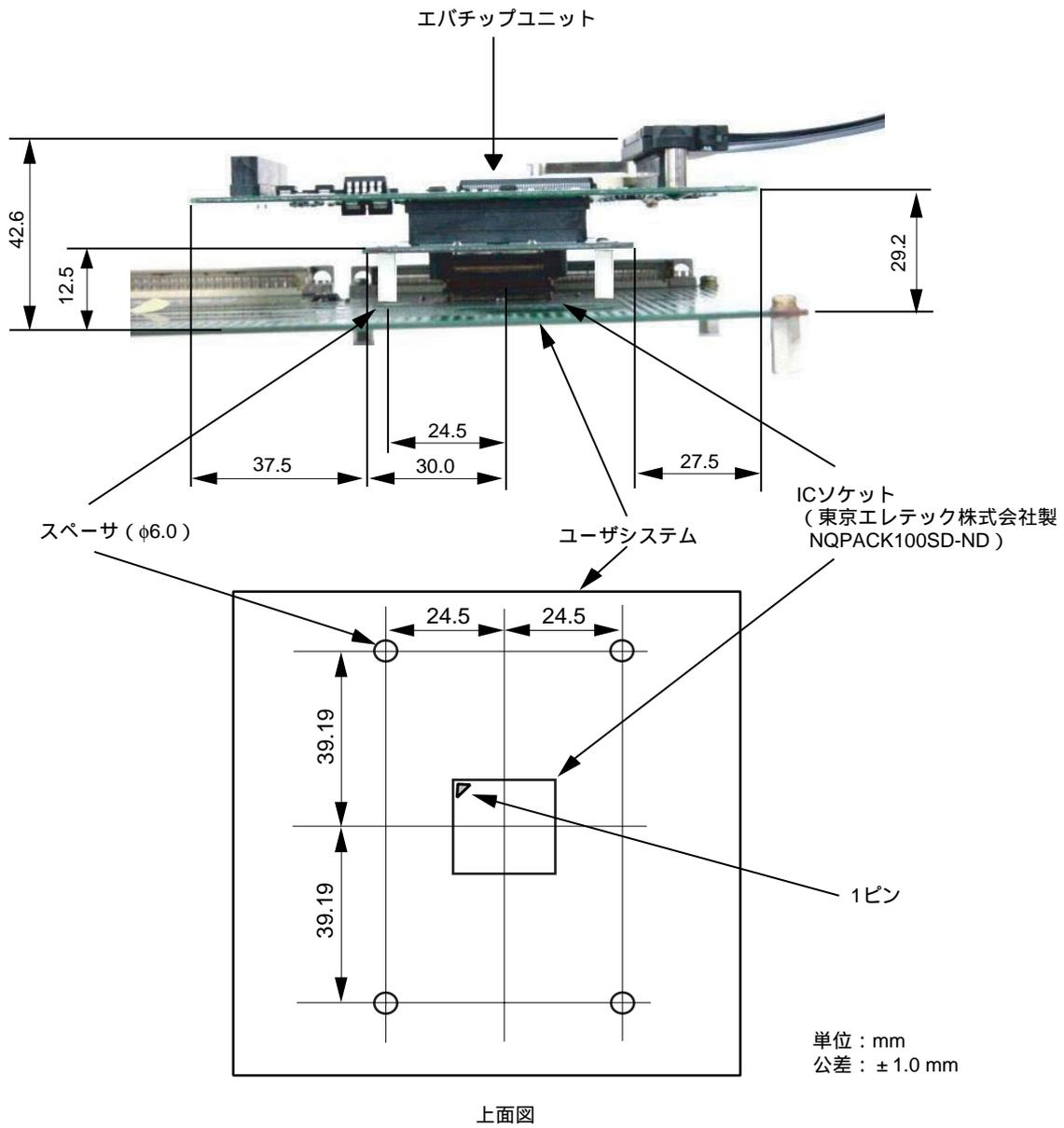
図 10 ユーザーシステムインタフェースボード接続時のユーザーシステムとの寸法
