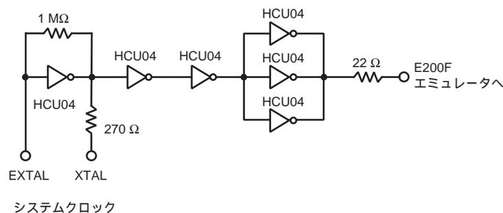
図 1 2 クロック発振回路
