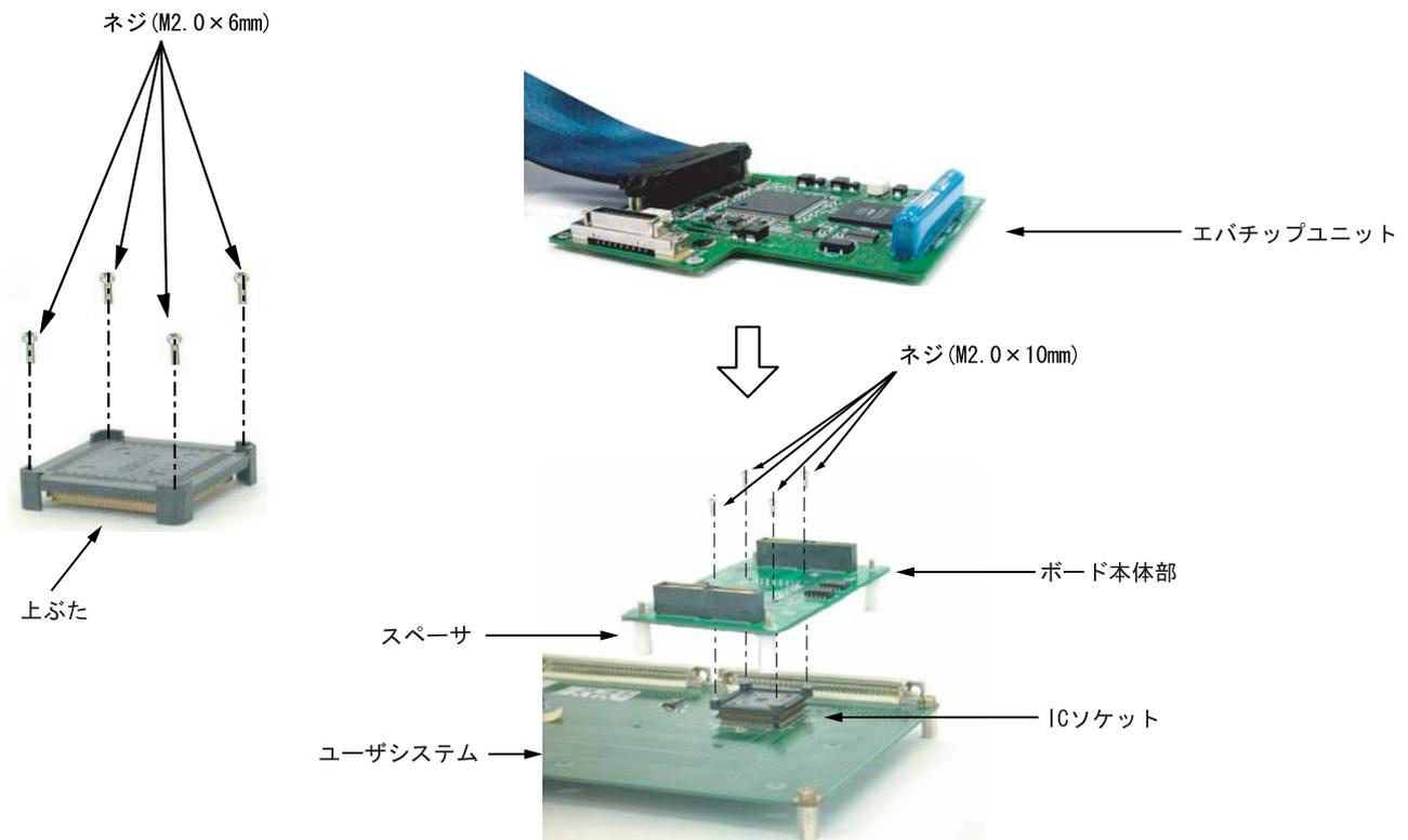
図 1 SH7137 PLQP0100KB-A 用ユーザシステムインタフェースボード
