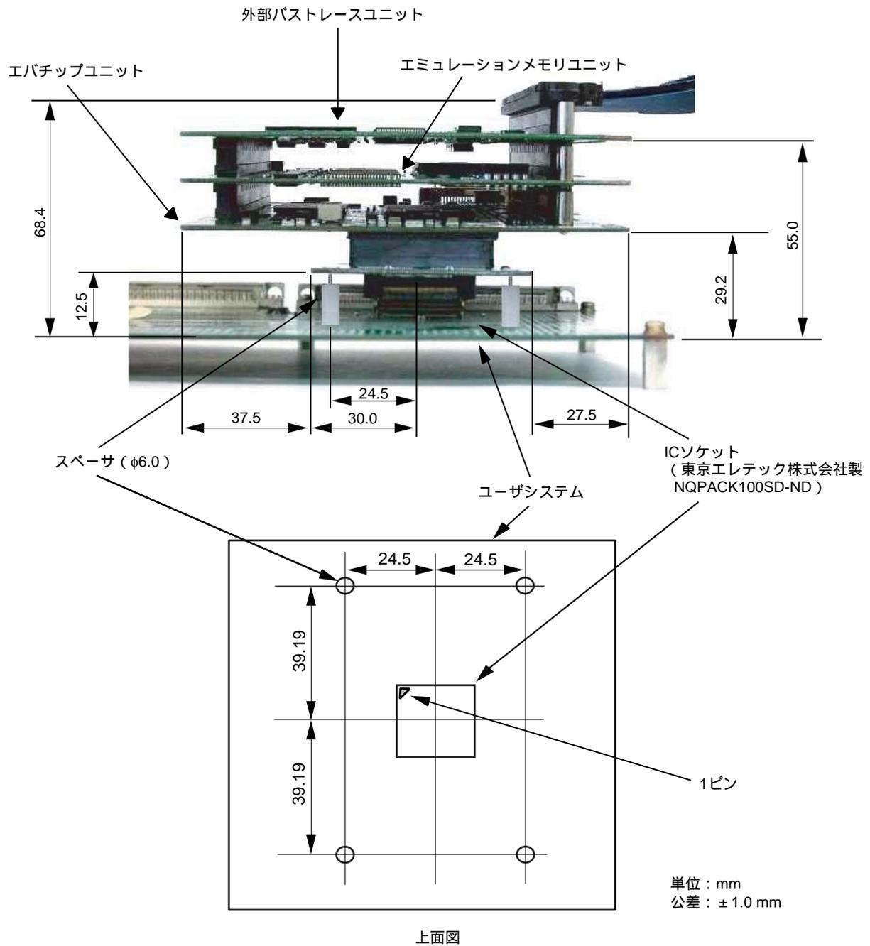
図8 ユーザシステムインタフェースボード接続時のユーザシステムとの寸法
