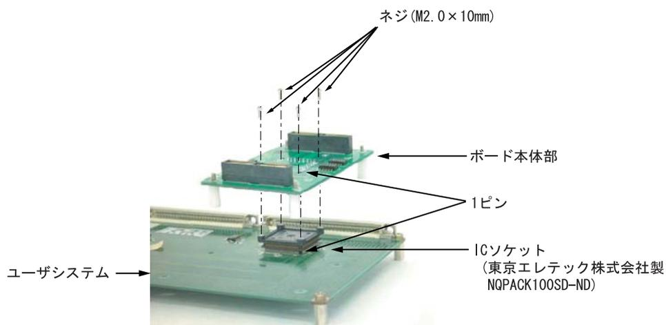
図4 ユーザシステムへの接続
