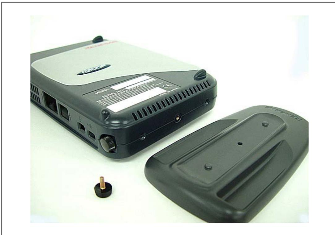
図 2.7 縦置き用ベース筐体の取り外し
