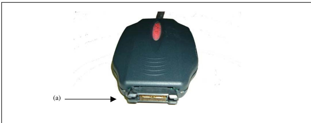
図 1.12 38ピン先端プローブの正面 (型名: R0E0200F2EMU00)
