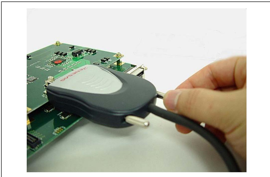
図 2.15 ユーザシステムと H-UDI/AUD プローブの固定方法
