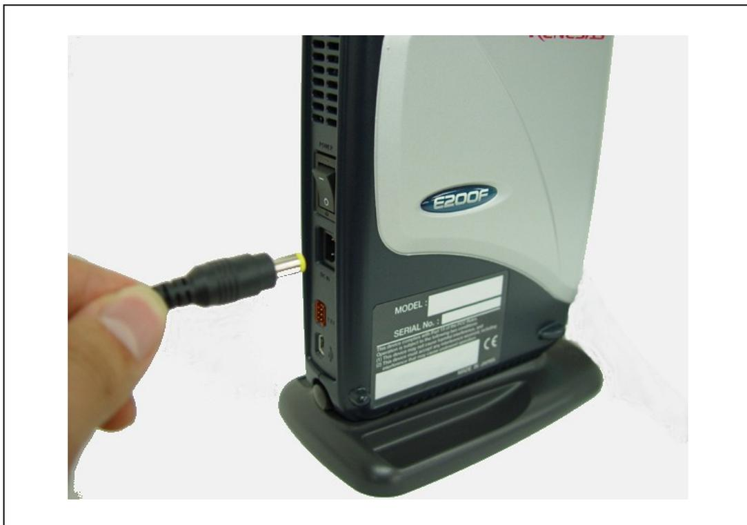
図 2.12 AC アダプタの接続方法
