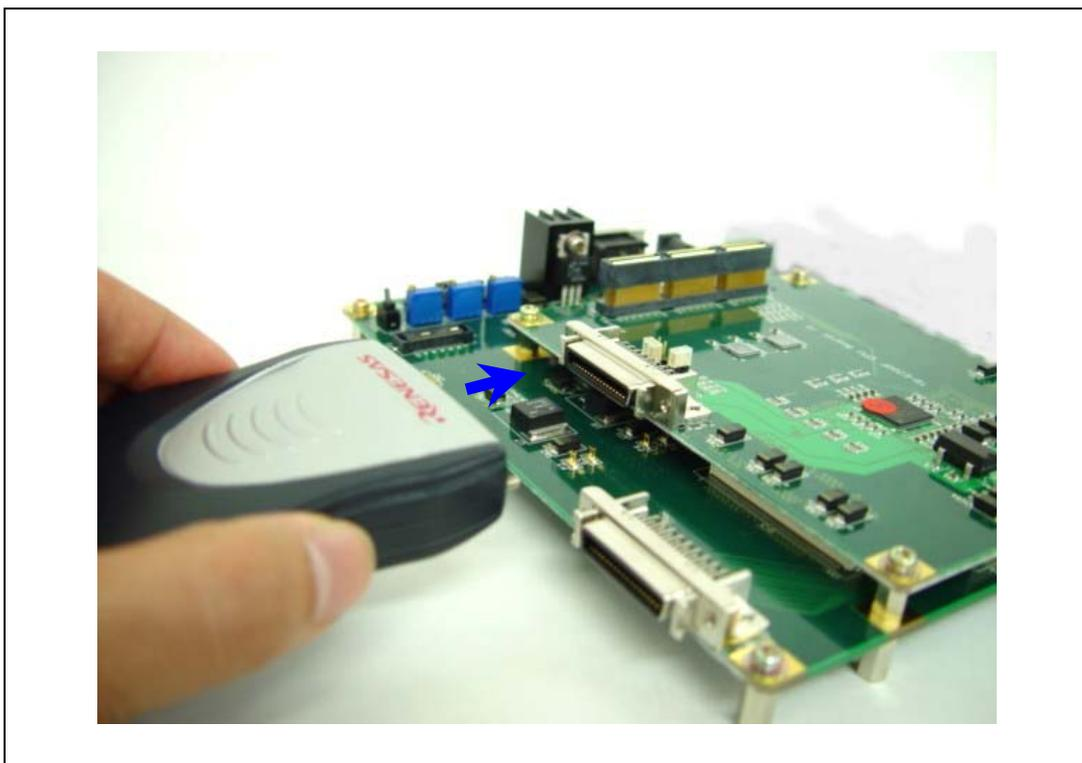
図 2.14 E200F とユーザシステムの H-UDI/AUD プローブ接続方法
