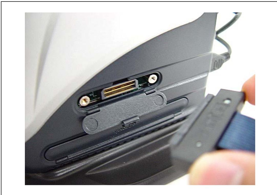
図 2.5 周辺 I/O アナライザユニット使用時の E200F 側のアナライザケーブル接続方法
