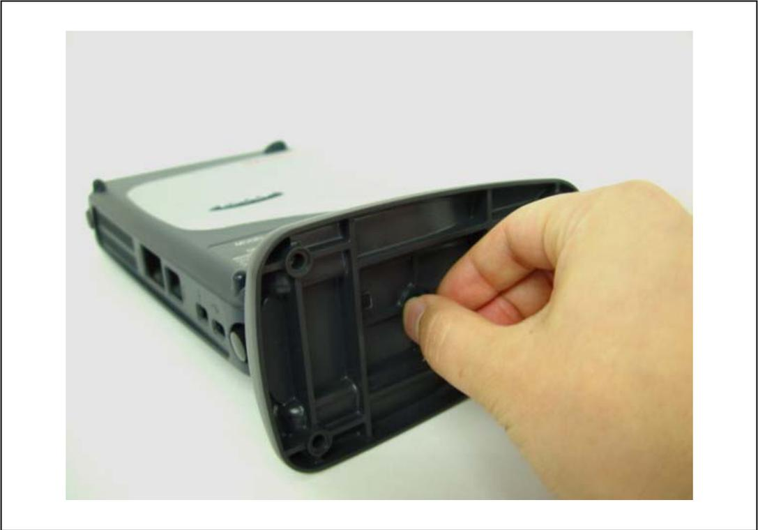
図 2.6 縦置き用ベース筐体のネジ
