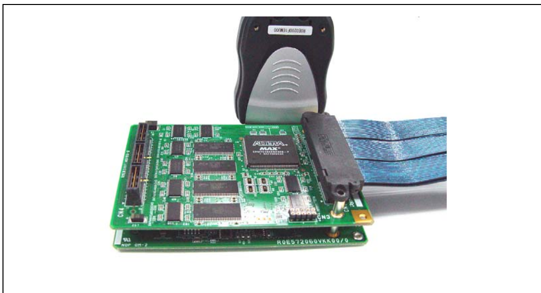
図 2.7 エミュレーションメモリユニット、エバチップユニット、およびトレースケーブルの接続方法
