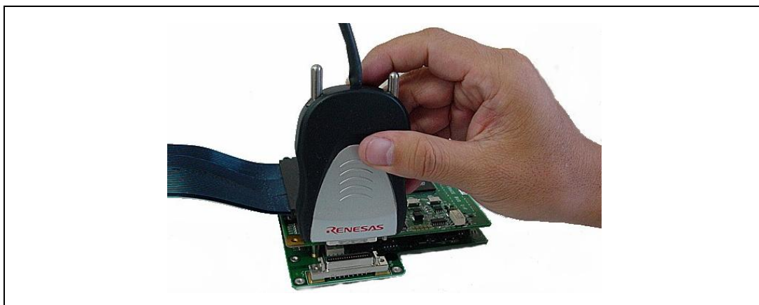
図 2.5 H-UDI/AUD プローブとエバチップユニットの接続方法
