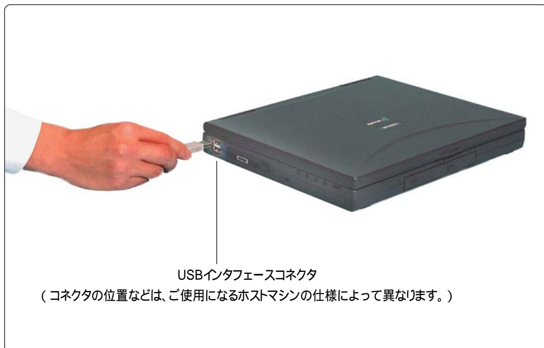
図4.5 USBインタフェースケーブルの接続 (ホストマシン側)
