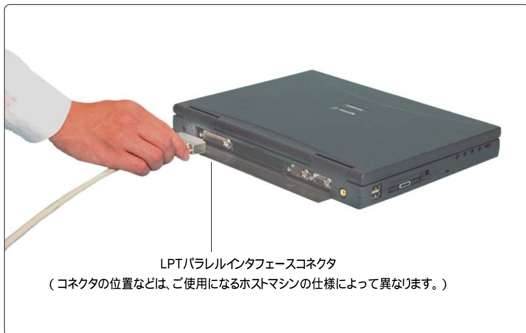
図4.7 LPTパラレルインタフェースケーブルの接続 (ホストマシン側)
