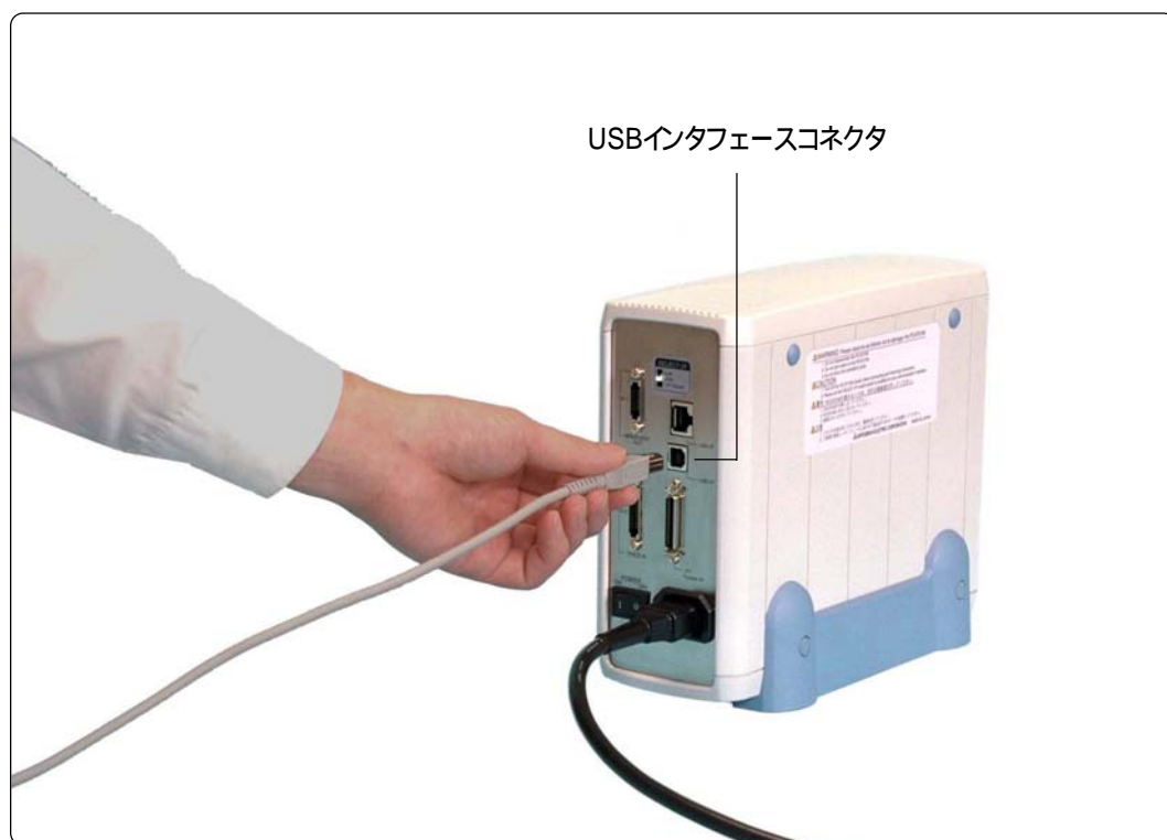
図4.6 USBインタフェースケーブルの接続 (エミュレータPC4701U側)
