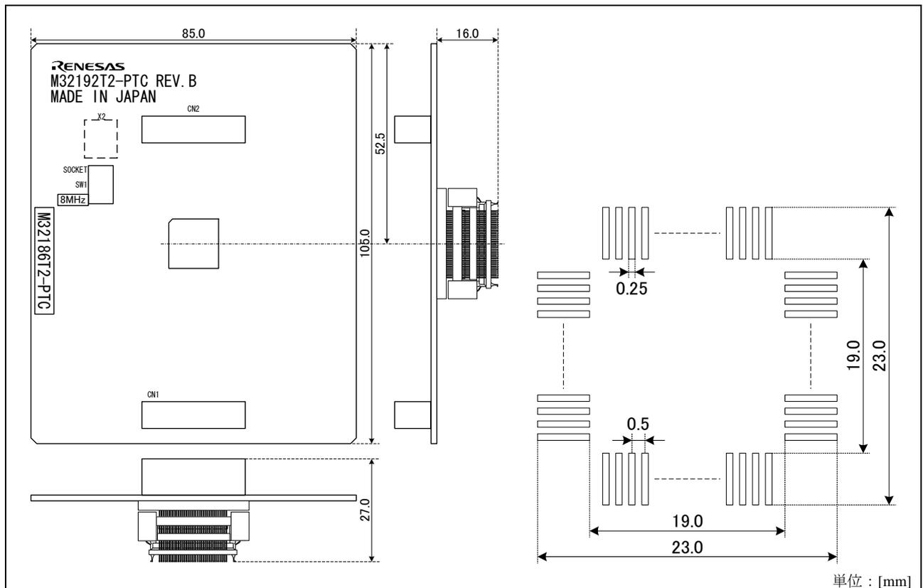
図7.1 M32186T2-PTC寸法図および参考フットパターン
