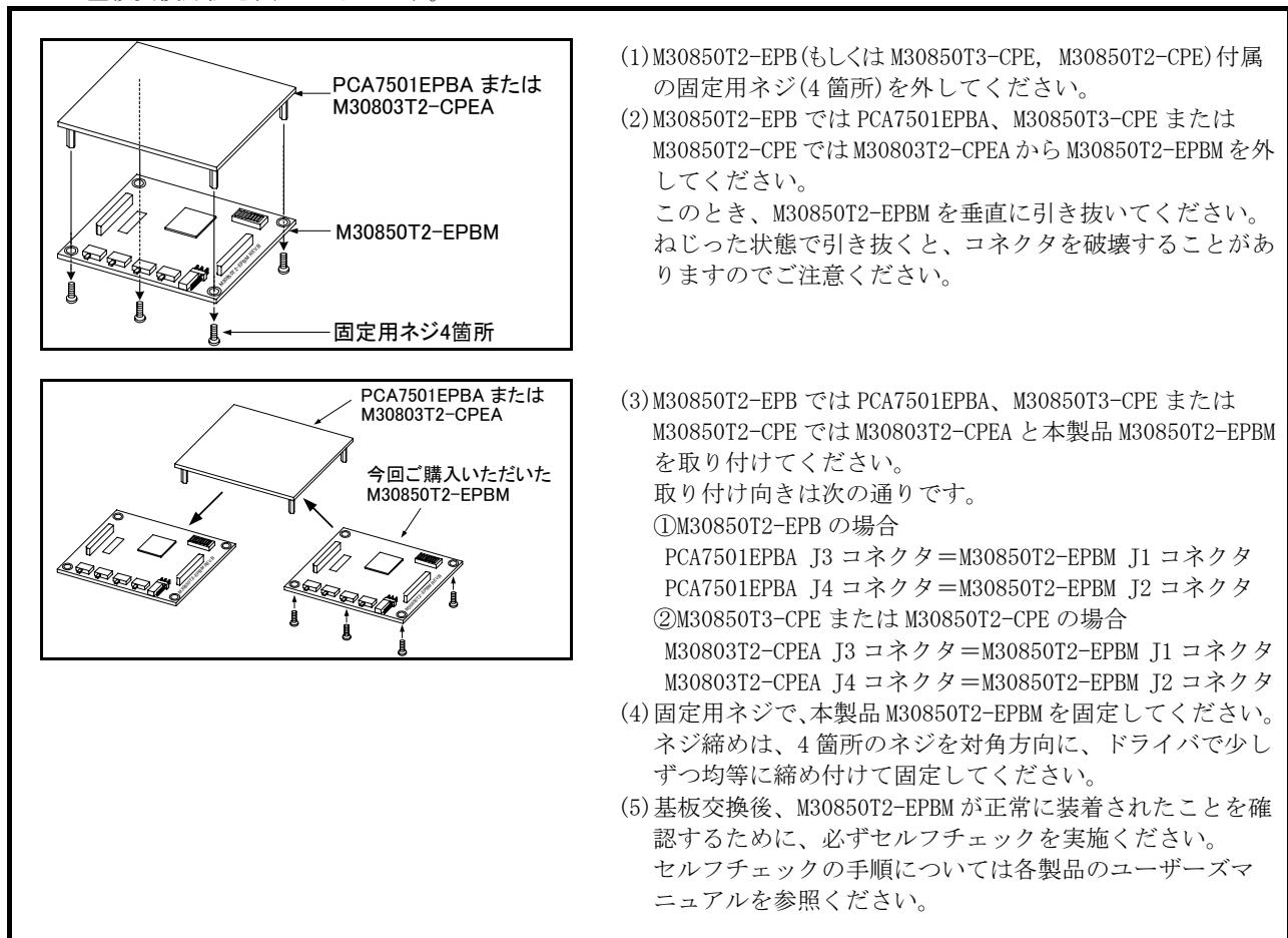
図3.1 MCU基板の交換方法
