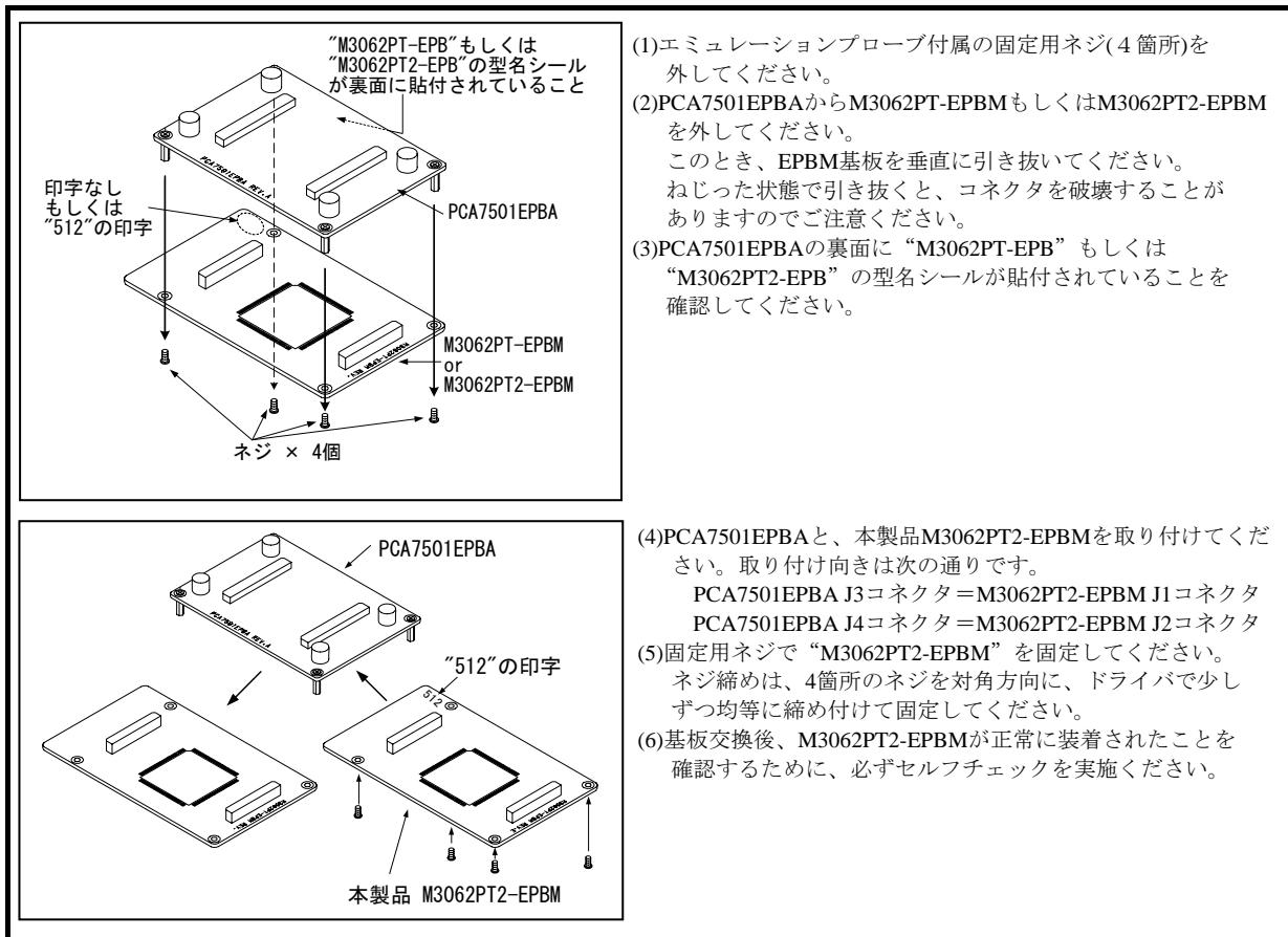
図3.1 MCU基板の交換方法
