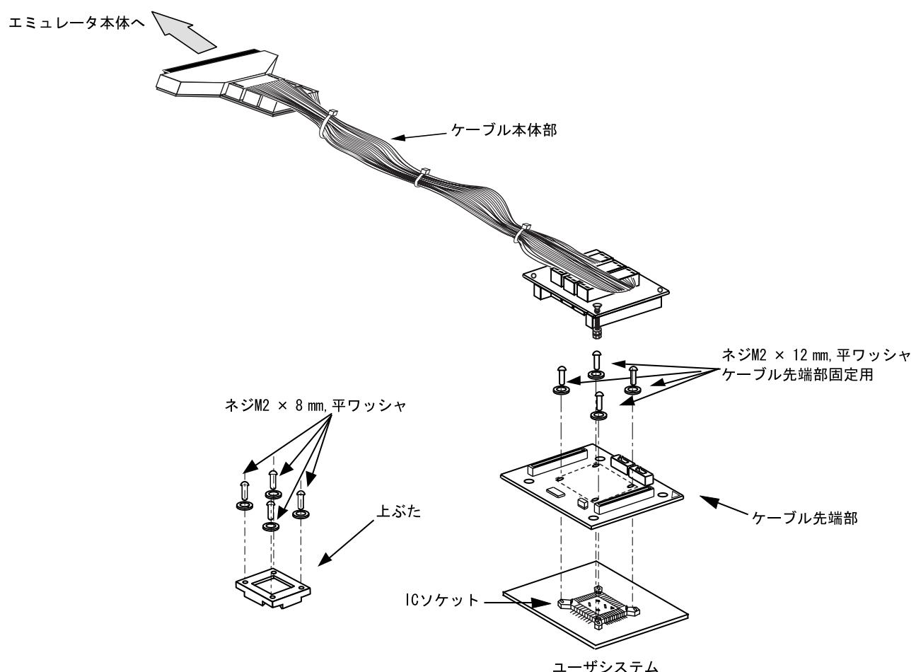
図 1 HS2615ECH61H ユーザシステムインターフェースケーブル
