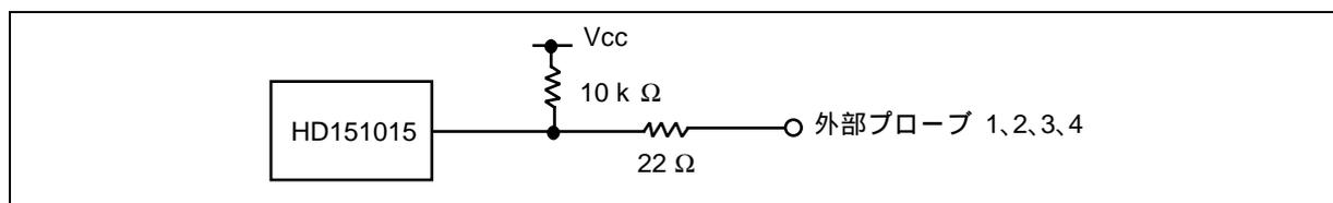
図 2-8 外部プローブ 1 インタフェース回路
