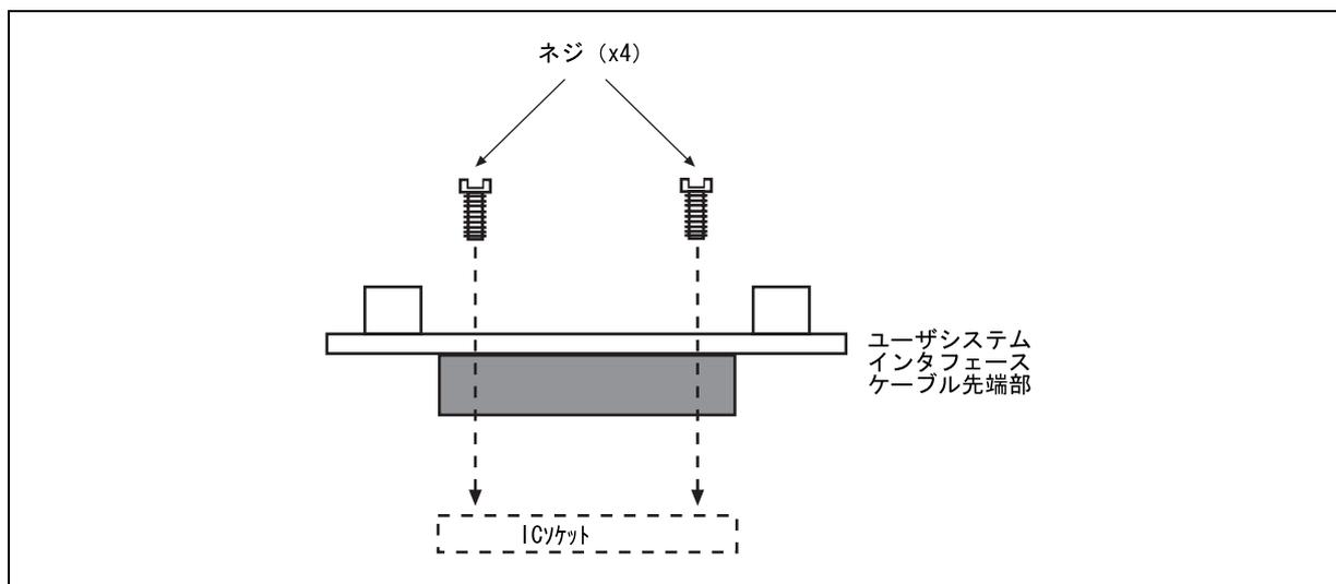
図 2-3 ユーザシステムインタフェースケーブルの接続
