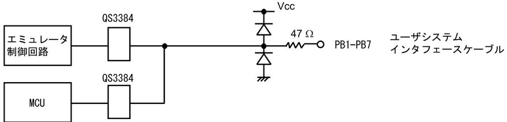
図 7-5 PB1-PB7 信号回路
