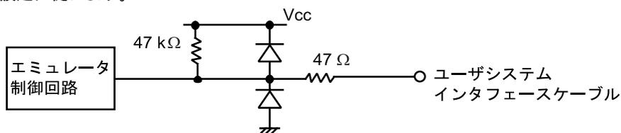
図 7-2 モード端子, NMI, WAIT, STBY 信号回路
