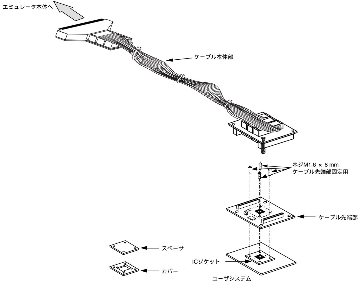
図1 HS2214ECB62H ユーザシステムインタフェースケーブル
