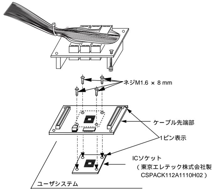
図3 ICソケットへの装着
