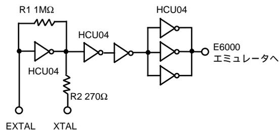
図 11 クロック発振回路
