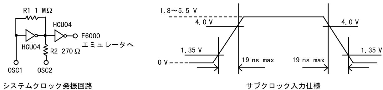
図 10 システムクロック発振回路およびサブクロック入力仕様
