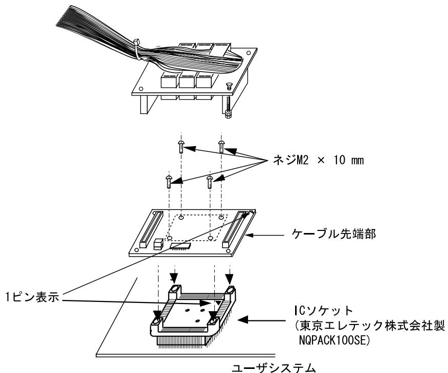
図4 IC ソケットへの装着
