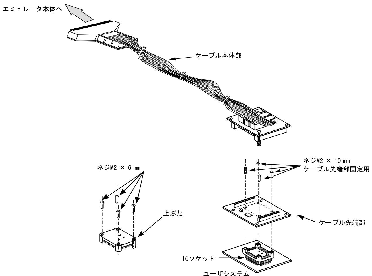
図 1 HS3887ECN61H ユーザシステムインターフェースケーブル
