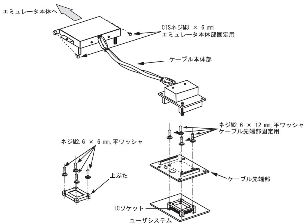
図 1 HS3064BECH61H ユーザシステムインタフェースケーブル
