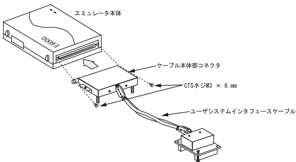
図2 エミュレータ本体への接続
