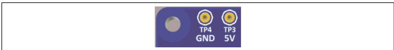
図 7 本評価キットボードのテストポイント TP3 および TP4
