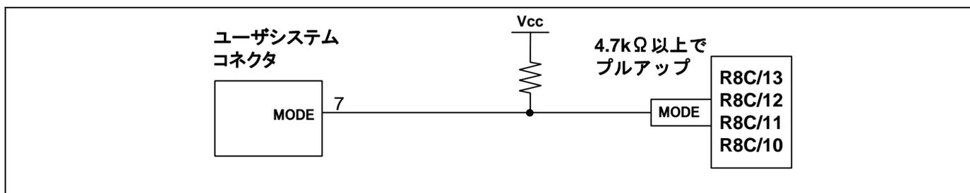
図5.3 E8a エミュレータと MODE 端子の接続
