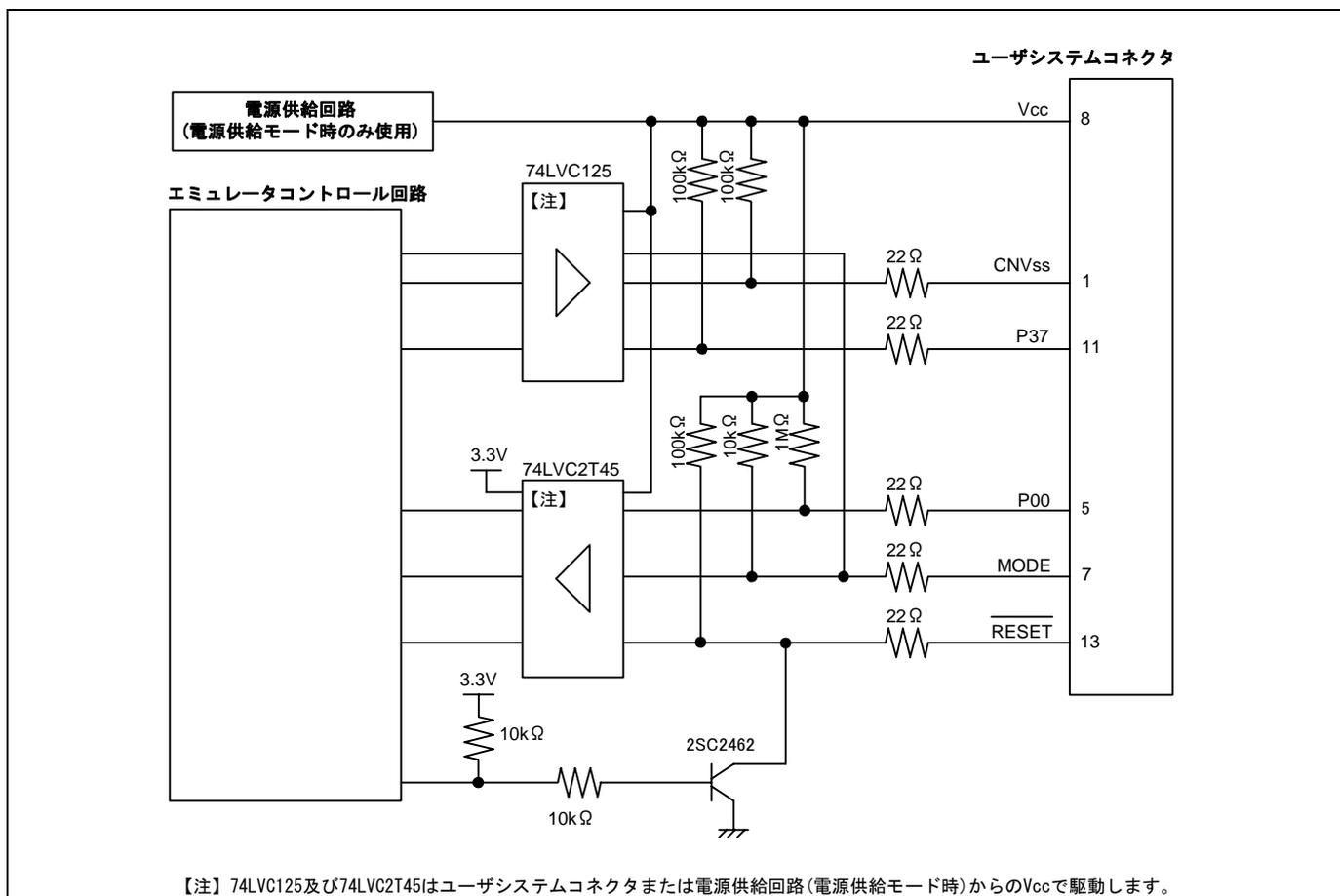
図5.6 E8a エミュレータ内インタフェース回路 (参考)
