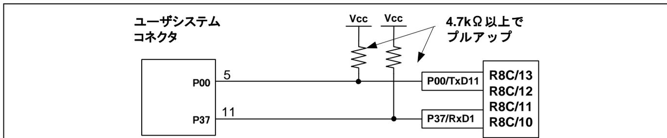
図5.2 E8a エミュレータとマイコンの接続
