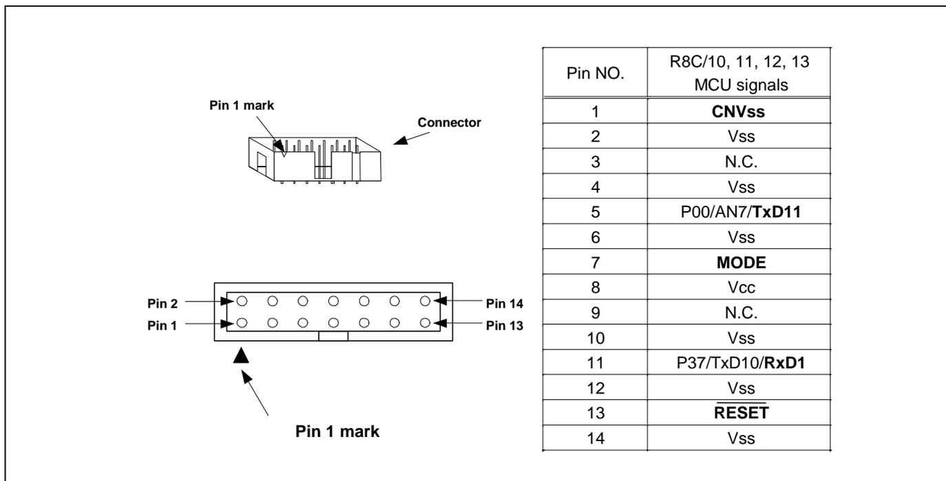
図4.1 E8a 接続コネクタのピン配置
