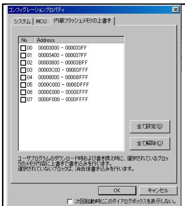
図 4.33 [コンフィグレーションプロパティ]ダイアログボックス(内蔵フラッシュメモリの上書きタブ)
