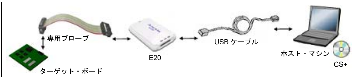
図 2.3 ホスト・マシンとデバッグ・ツールとの接続例【E20】
