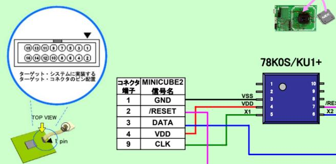
備考 クロックはMINICUBE2から供給します(8 MHz)。電源もMINICUBE2から供給可能です。その場合は電源選択スイッチを「3」または「5」にしてください。詳しくは **STEP4** を参照してください。
