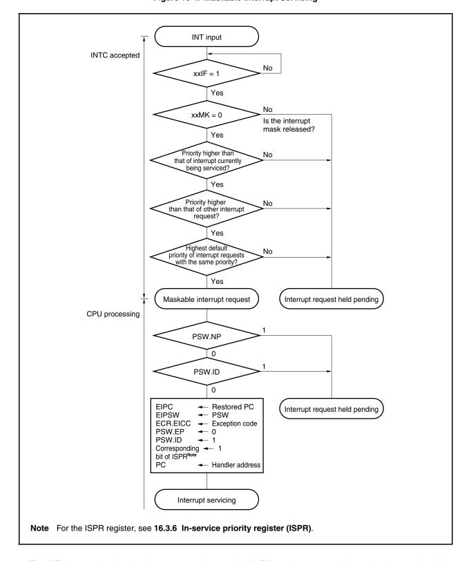
Figure 16-4. Maskable Interrupt Servicing
