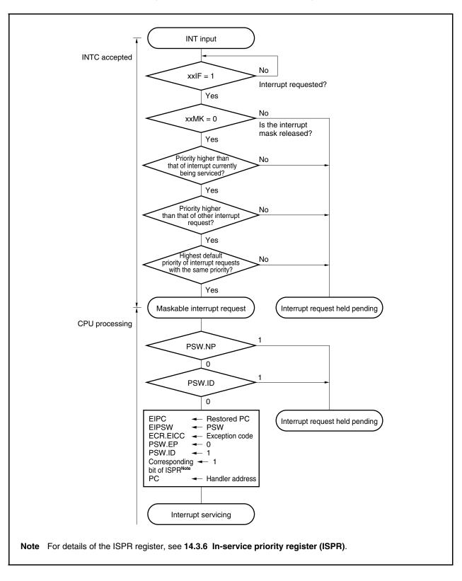
Figure 14-3. Maskable Interrupt Servicing
