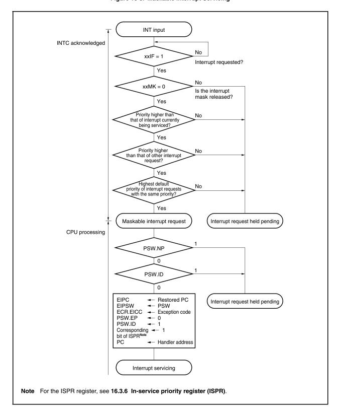
Figure 16-5. Maskable Interrupt Servicing
