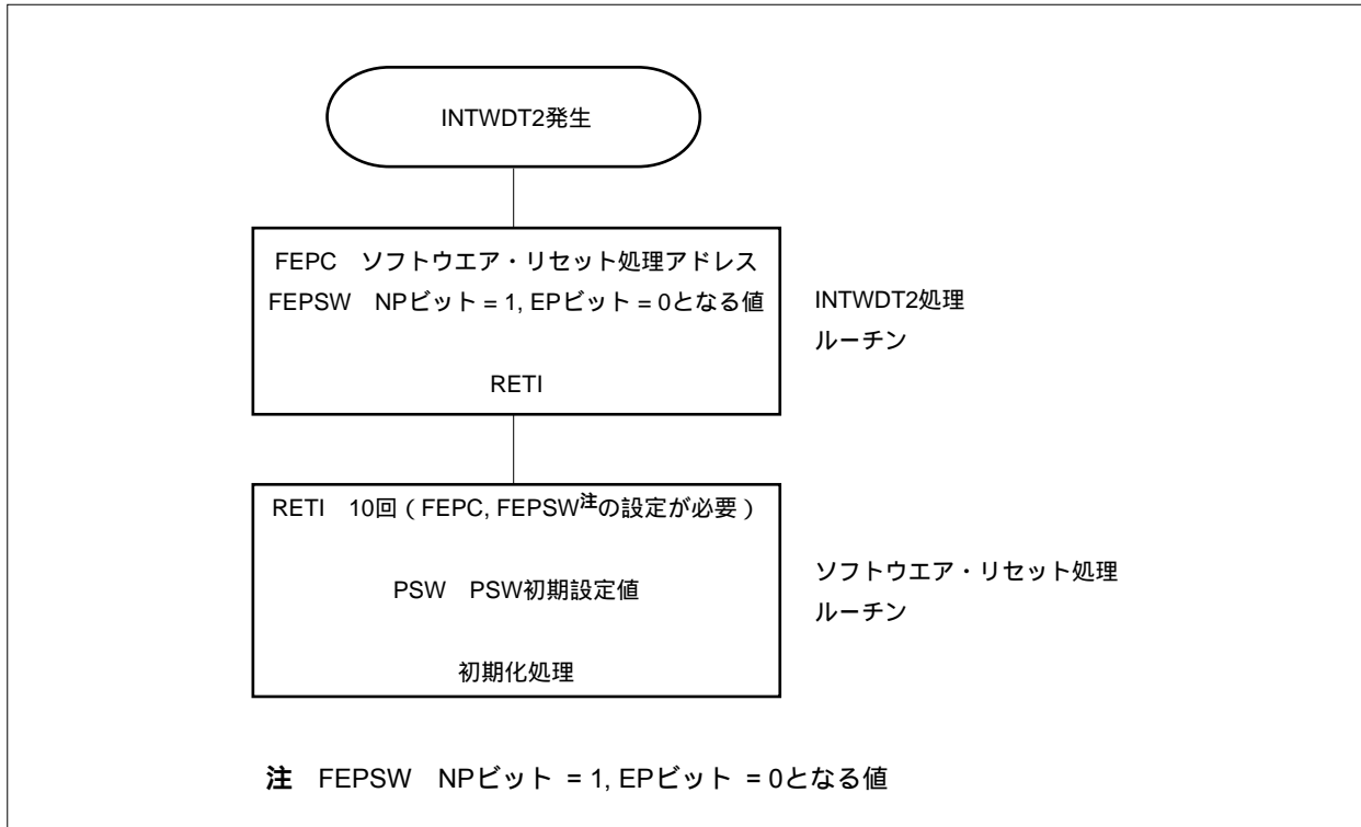
図14-4 ソフトウェア・リセット処理
