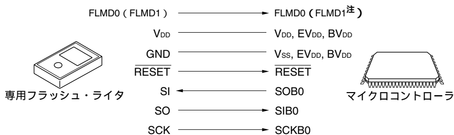
図7-4 専用フラッシュ・ライターとの通信 (ハンドシェークなしCSIB0)
