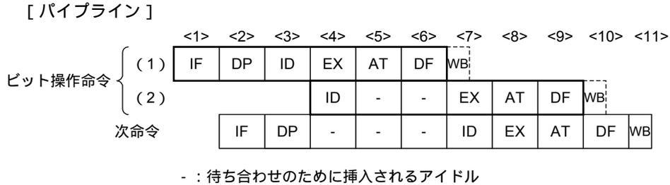
[説明] ID ステージで 2 つの命令に分割され、最初にロード命令を、次にビット操作を含むストア命令を実行します。ただし、レジスタへのデータの書き込みがないので、WB ステージでは何も行いません。この図では、Lpipe でビット操作命令が実行され、Lpipe に次命令が発行された場合の動作を示しています。命令実行パイプライン・ライト (Rpipe) はビット操作命令と依存関係がないかぎり独立に処理を実行します。ID ステージで命令をデコードしている期間はディスパッチ・ユニットは Lpipe には命令を発行しません。各命令は単独で発行されます。
