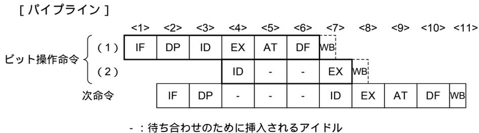
[説明] ID ステージで 2 つの命令に分割され、最初にロード命令を、次にビット操作命令を実行します。ただし、レジスタへのデータの書き込みがないので、WB ステージでは何も行いません。この図では、Lpipe で TST1 命令が実行され、Lpipe に次命令が発行された場合の動作を示しています。Rpipe はビット操作命令と依存関係がないかぎり独立に処理を実行します。ID ステージで命令をデコードしている期間はディスパッチ・ユニットは Lpipe には命令を発行しません。各命令は単独で発行されます。
