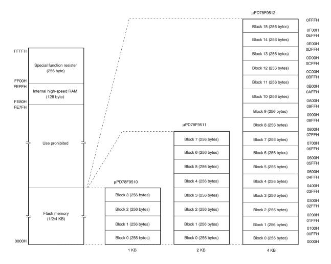
Figure 15-1. Flash Memory Mapping
