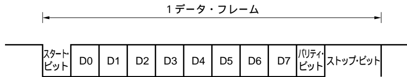
図11-7 アシンクロナス・シリアル・インタフェースの送受信データのフォーマット
