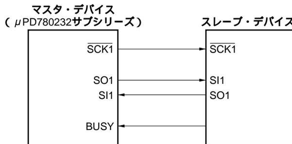
マスタ・デバイスは、スレーブ・デバイスが出力するビジィ信号をBUSY/P24端子に入力します。マスタ・デバイスはシリアル・クロックの立ち下がりに同期して、入力したビジィ信号をサンプリングします。8ビット・データの送受信中にビジィ信号がアクティブになっても、ウエイトはかかりません。8ビット・データの送受信が終了してから2クロック後のシリアル・クロックの立ち上がり時にビジィ信号がアクティブであれば、その時点ではじめてビジィ入力が有効となり、それ以降、ビジィ信号がアクティブな期間は送受信にウエイトがかかります。
