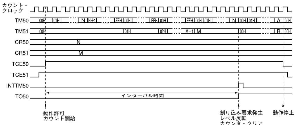
図9-13 16ビット分解能カスケード接続モード
