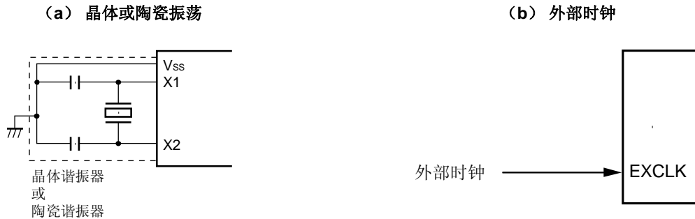
图 5-9. X1 振荡器外部电路示例
