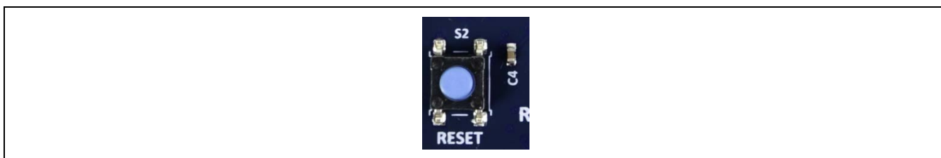
図16 ターゲットボード上のリセットスイッチ (S2)
