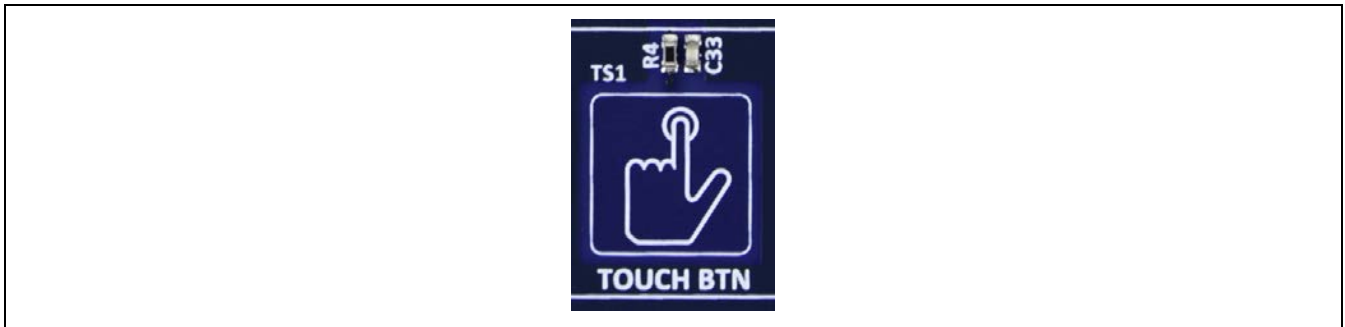
図19 ターゲットボード上の静電容量式タッチボタン（上面）
