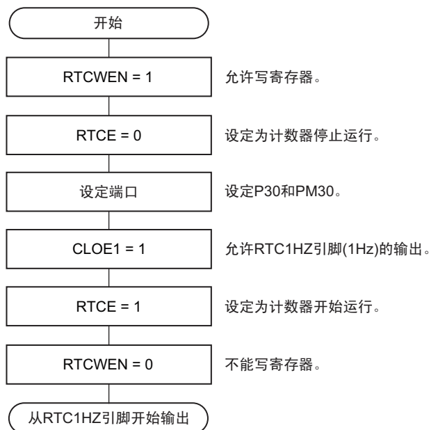
图 8-22 1Hz 输出的设定步骤
