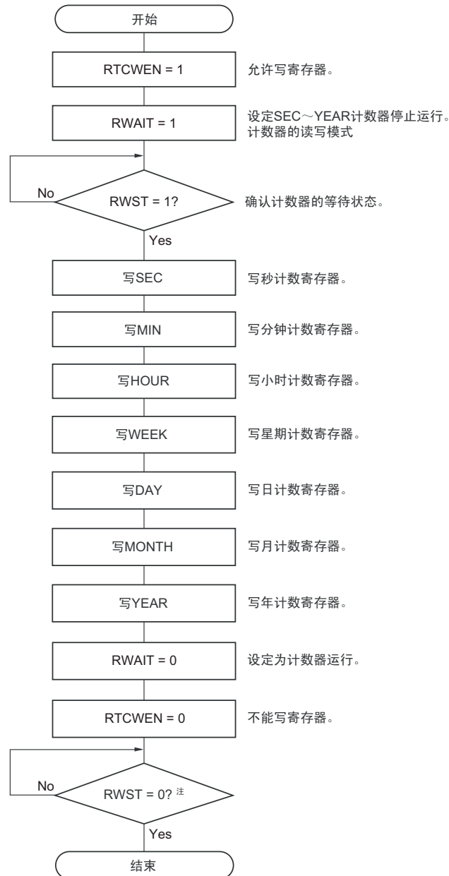
图 8-20 高精度实时时钟计数器的写操作步骤
