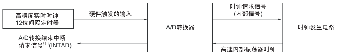
图 12-31 使用 SNOOZE 模式功能时的框图
