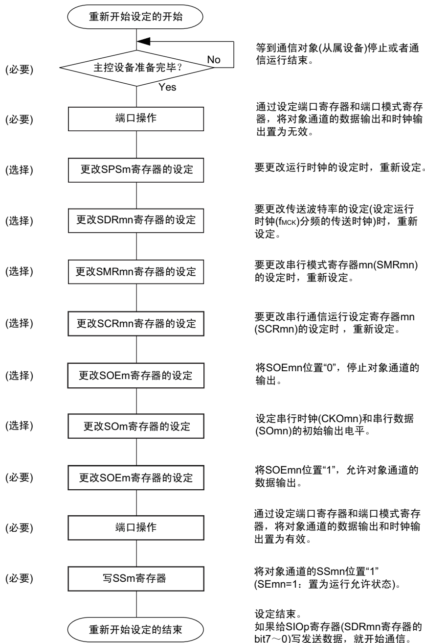
图 14-29 主控发送的重新开始设定步骤
