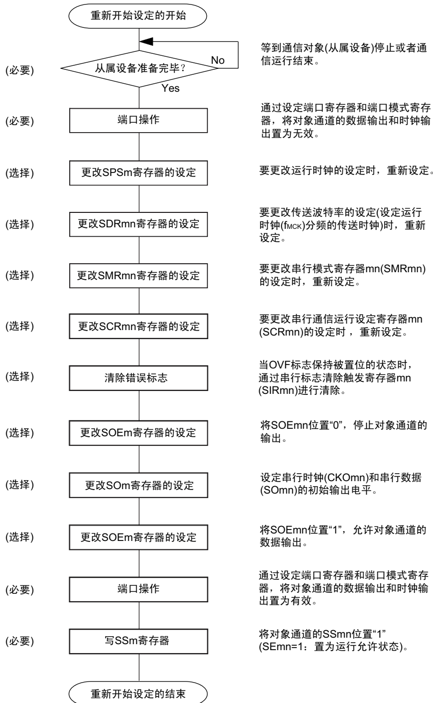
图 14-45 主控发送和接收的重新开始设定步骤
