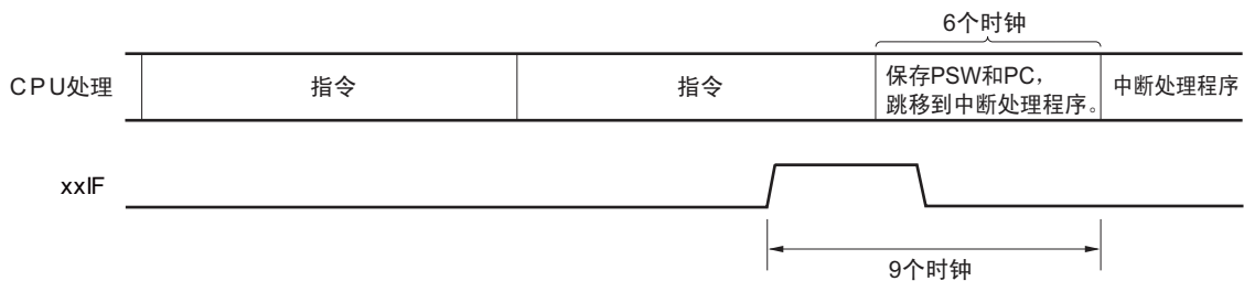
图 19-8 中断请求的接受时序（最短时间）
