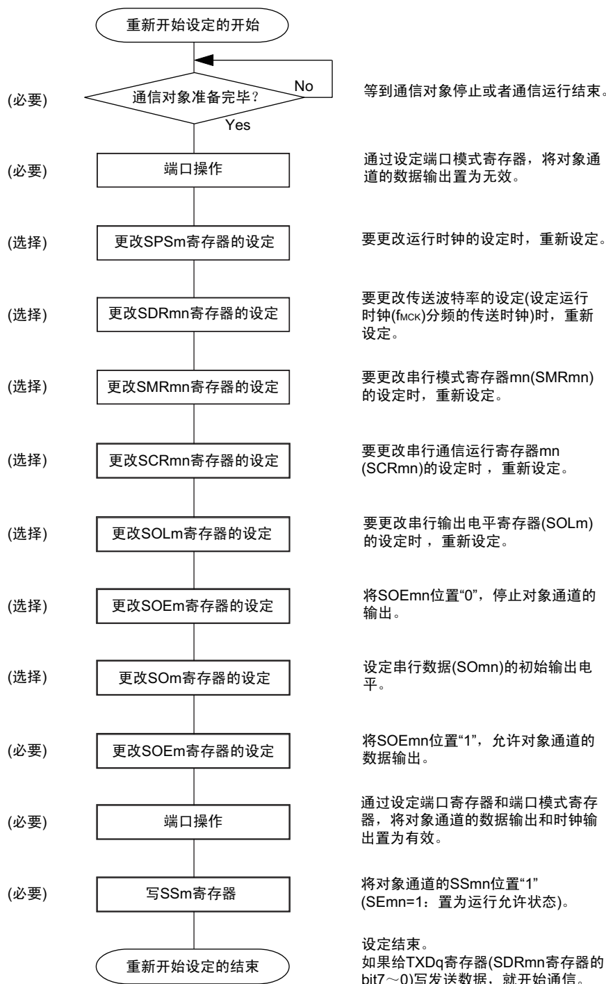
图 14-80 UART 发送的重新开始设定步骤
