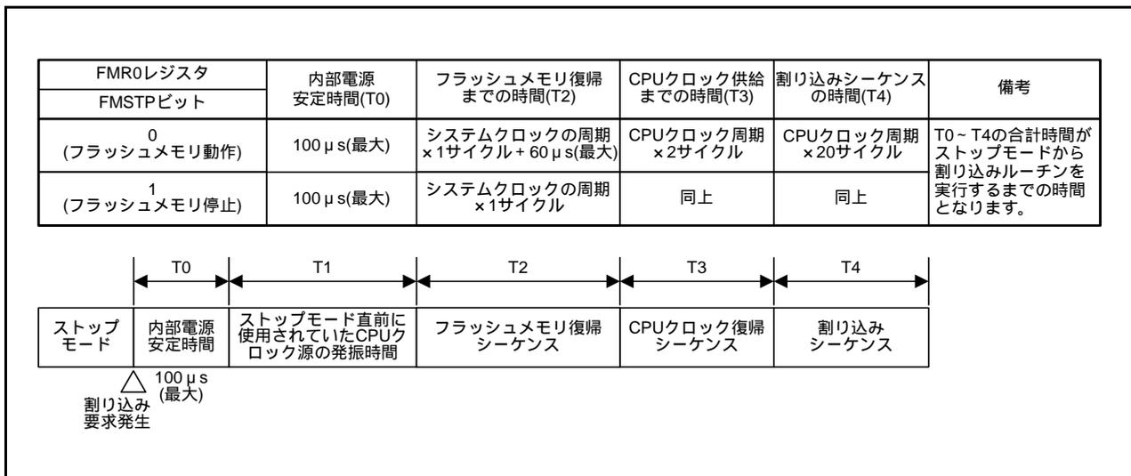
図9.9 ストップモードから割り込みルーチンを実行するまでの時間
