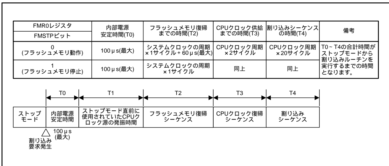
図9.7 ストップモードから割り込みルーチンを実行するまでの時間
