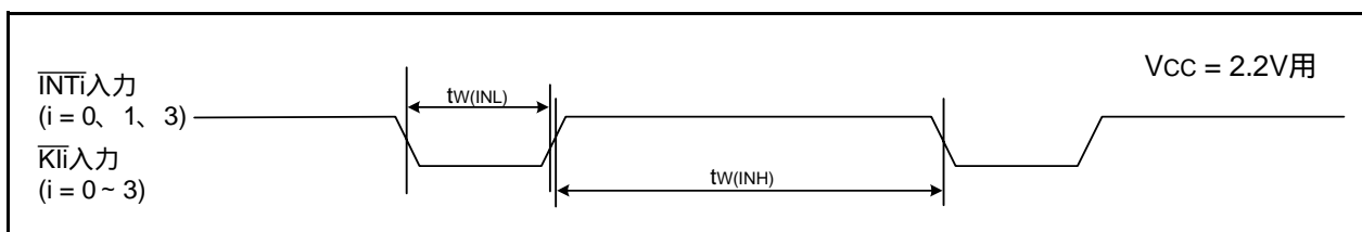
図26.15 Vcc = 2.2V時の外部割り込み \overline{INTi} およびキー入力割り込み \overline{Kli} 入力タイミング
