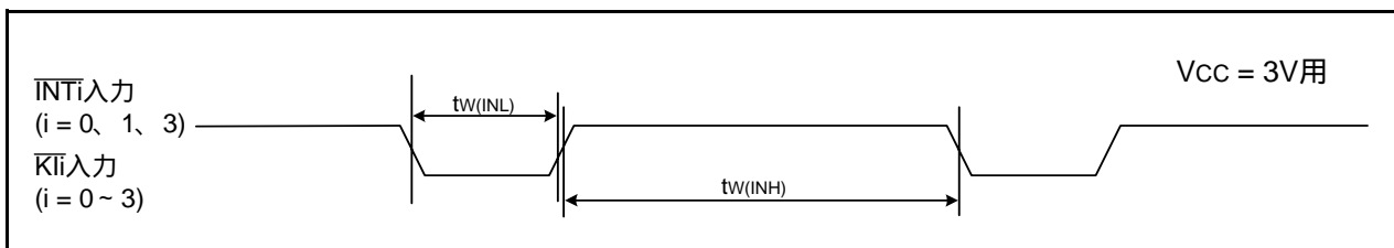
図26.11 Vcc = 3V時の外部割り込み \overline{INTi} およびキー入力割り込み \overline{Kli} 入力タイミング
