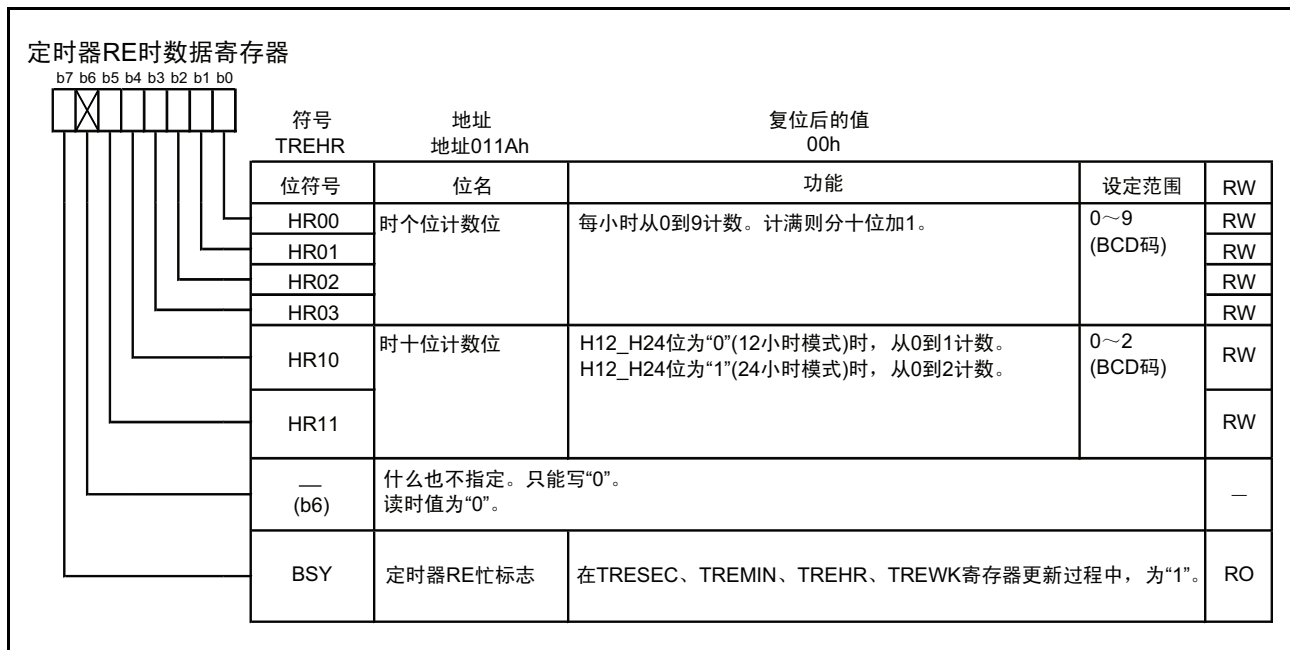
图 15.64 实时时钟模式时的 TREHR 寄存器
