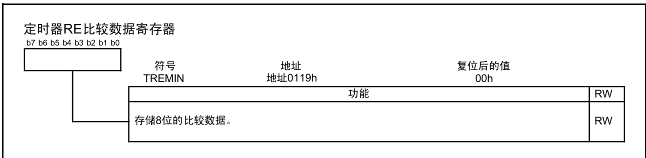
图 15.73 输出比较模式时的 TREMIN 寄存器
