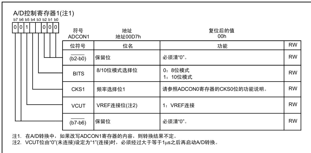
图 19.5 单次模式时的 ADCON1 寄存器
