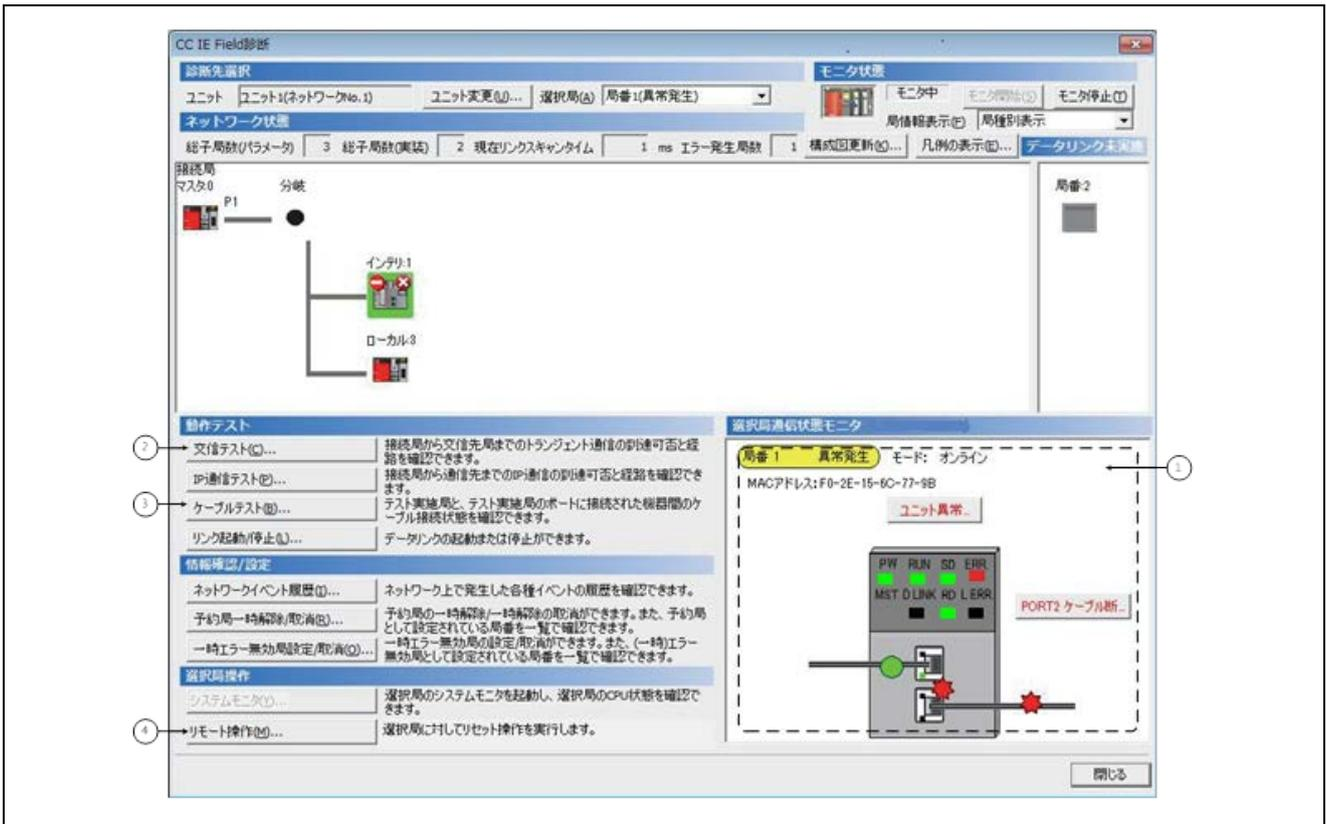
図2.1 診断画面の表示／操作箇所 (GX Works2 の場合)
