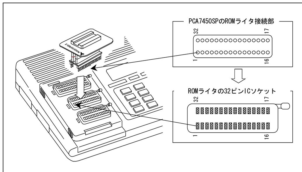
図 4.2 ROMライターへのセット方法 (PCA7450SPの場合)
