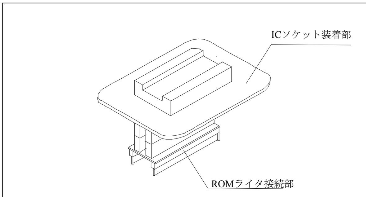
図 2.2 外形と構成部品 (PCA7450SPの場合)
