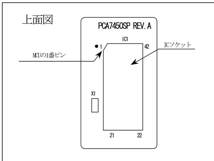
図 4.4 MCUの装着方法 (PCA7450SPの場合)
