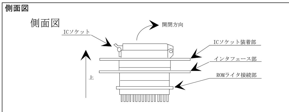
図 4.5 ソケット開閉時の状態
