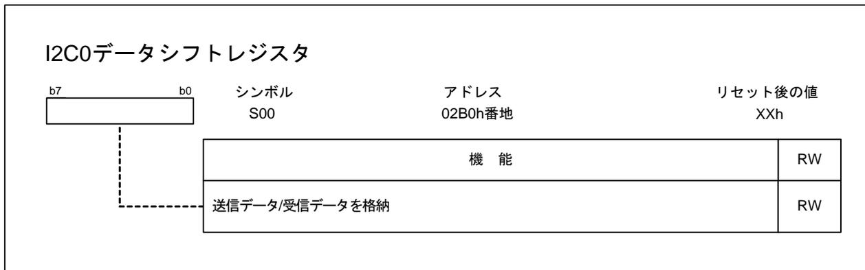
送信時は送信データを書き込んでください。受信時はS00レジスタを読み出すと受信データが読み出せます。マスタモードでは、スタートコンディションまたはストップコンディションの発生にも使用します。(「22.3.2 スタートコンディション発生方法」「22.3.3 ストップコンディション発生方法」参照)。
