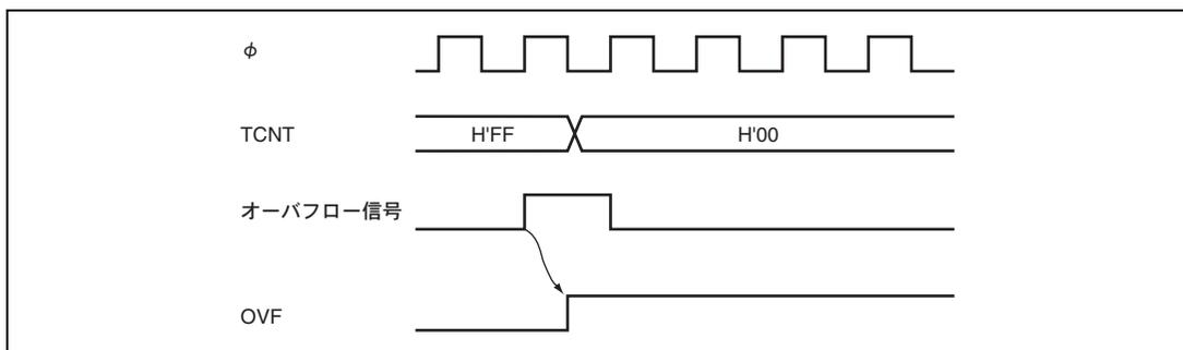
図 11.9 OVF フラグのセットタイミング
