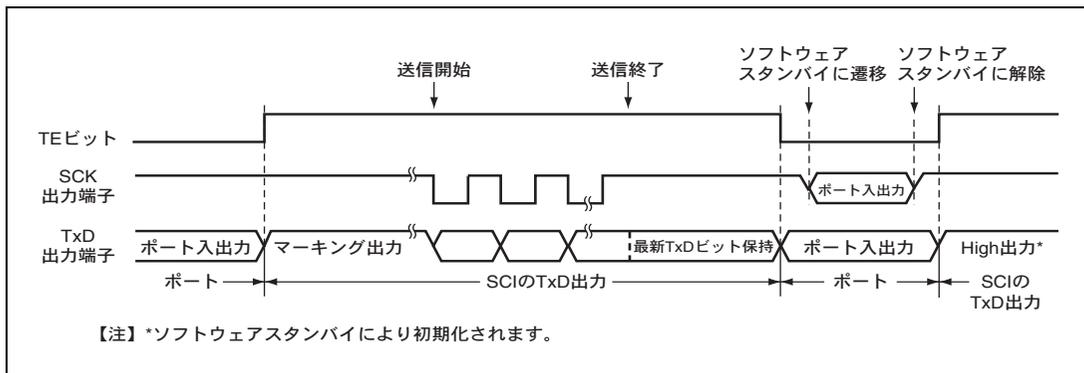
図 14.36 クロック同期式モード送信時（内部クロック）の端子状態
