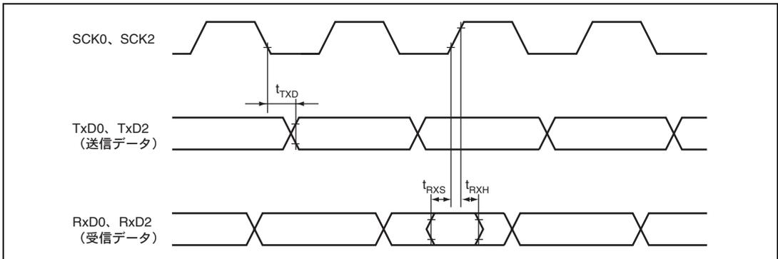
図 22.11 SCI 入出カタイミング/クロック同期式モード
