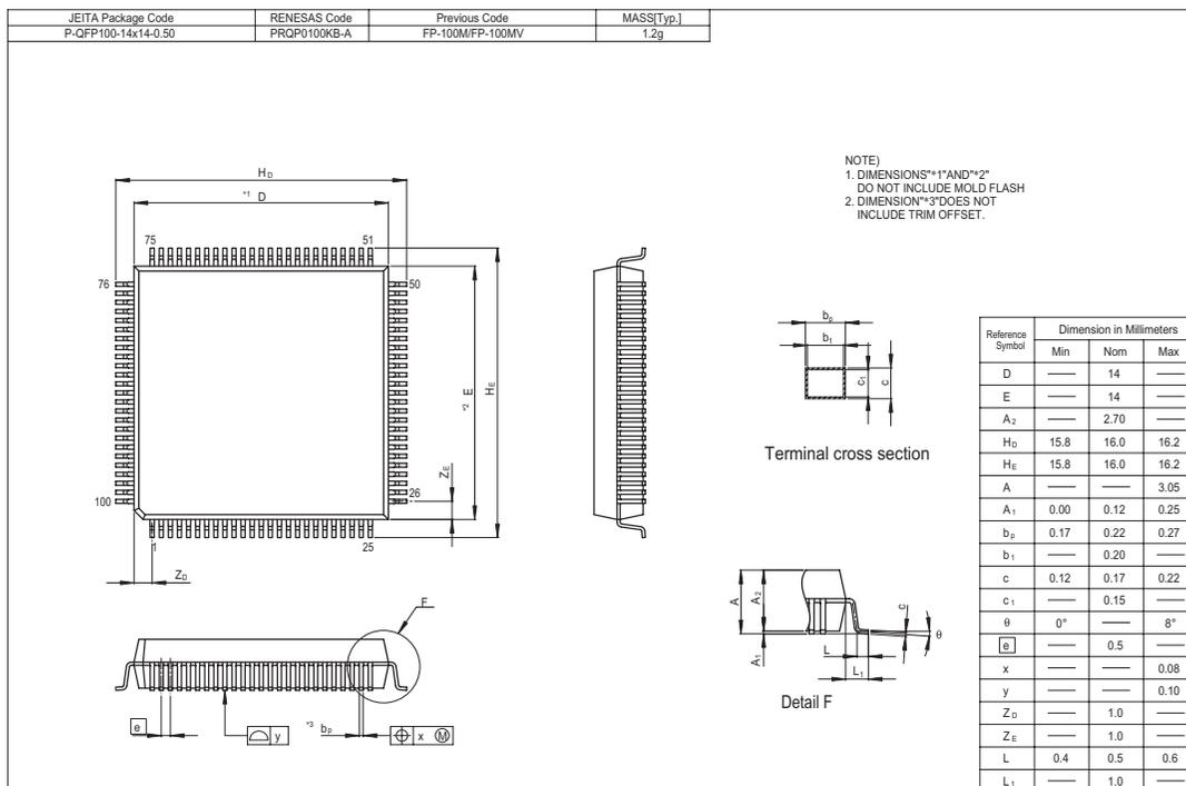
図 C.1 外形寸法図
