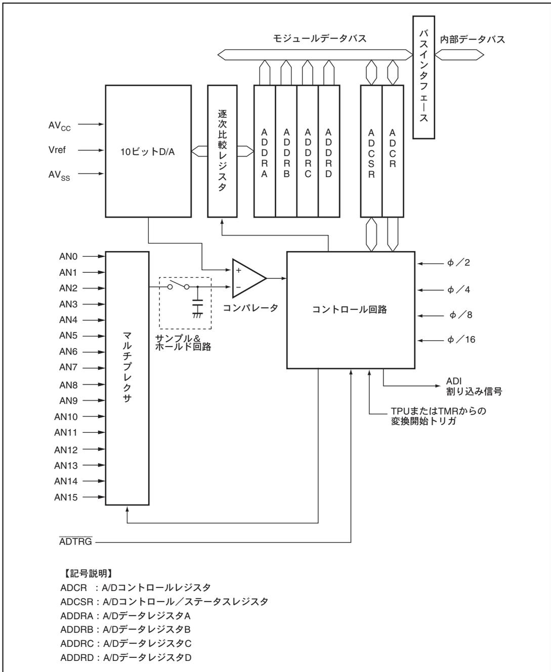
図 16.1 A/D 変換器のブロック図
