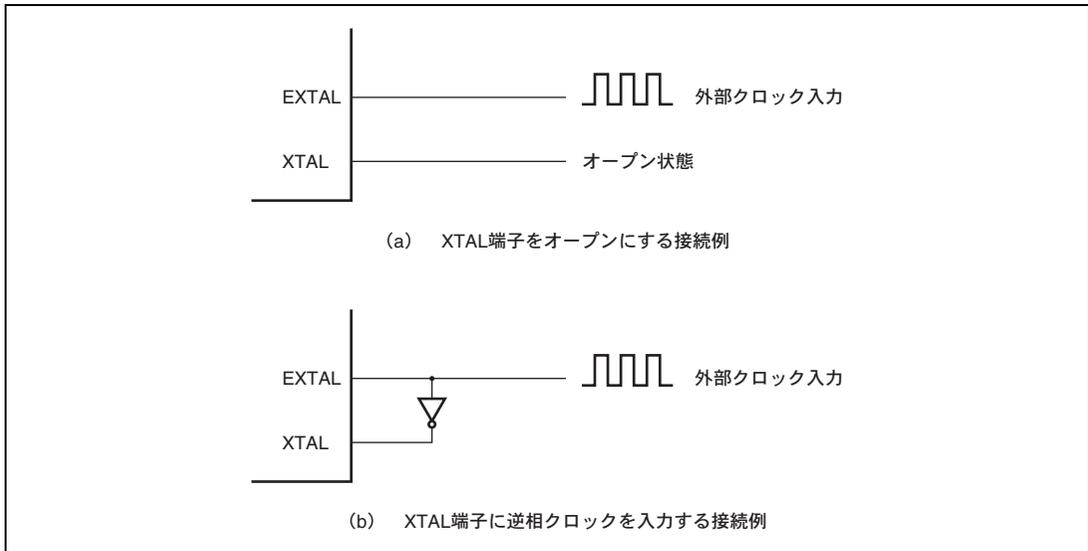
図 19.4 外部クロックの接続例
