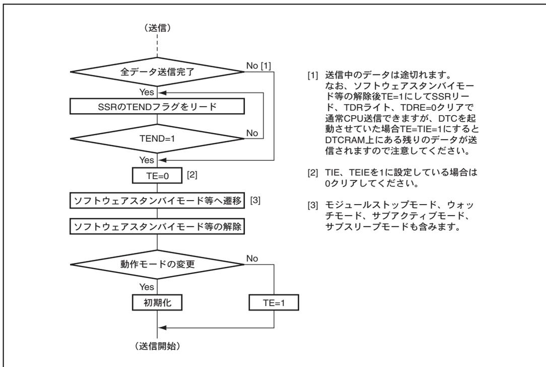
図 14.34 送信時のモード遷移フローチャートの例
