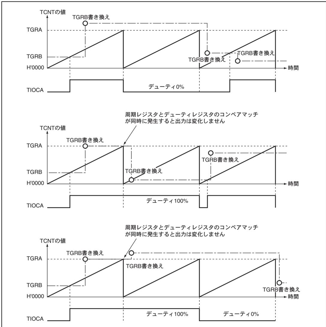
図 10.23 PWM モードの動作例 (3)
