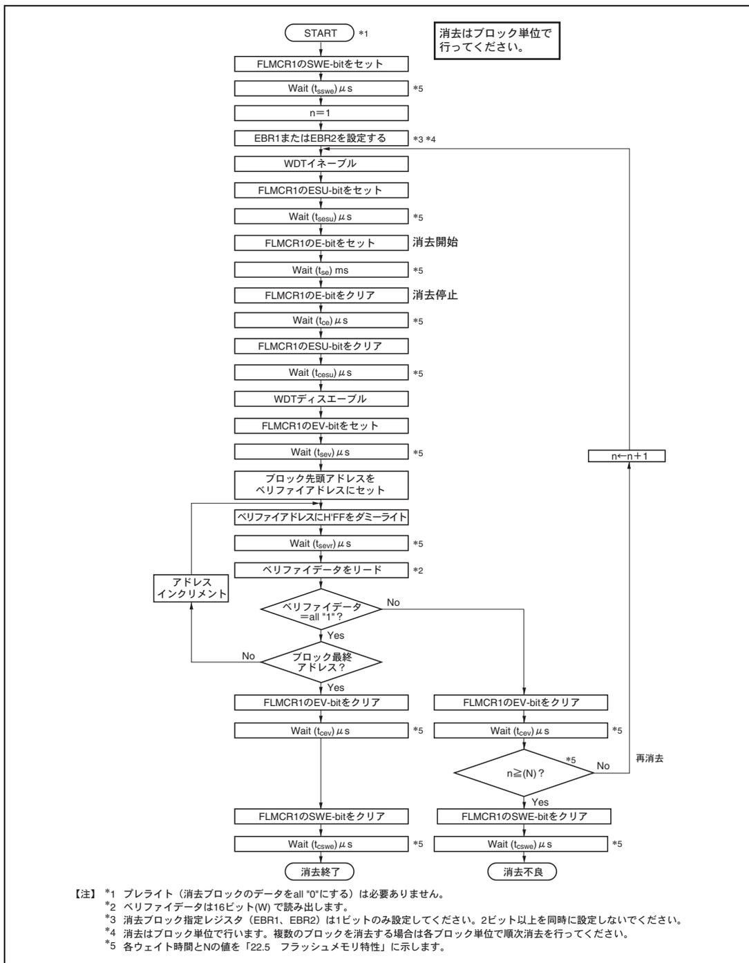
図 18.10 イレース/イレースペリファイフロー
