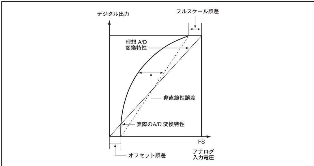
図 16.5 A/D 変換精度の定義
