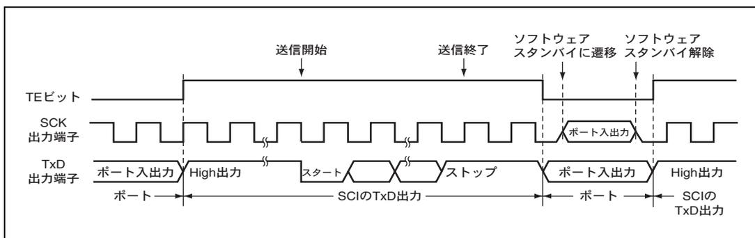
図 14.35 調歩同期式モード送信時（内部クロック）の端子状態
