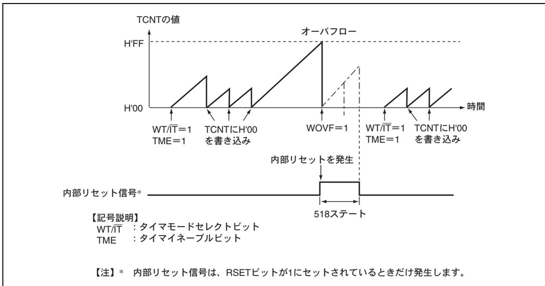
図 13.2 ウォッチドッグタイマモード時の動作例
