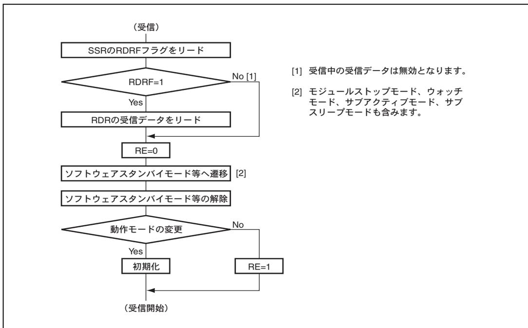
図 14.37 受信時のモード遷移フローチャートの例
