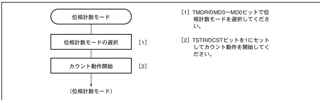
図 10.24 位相計数モードの設定手順例
