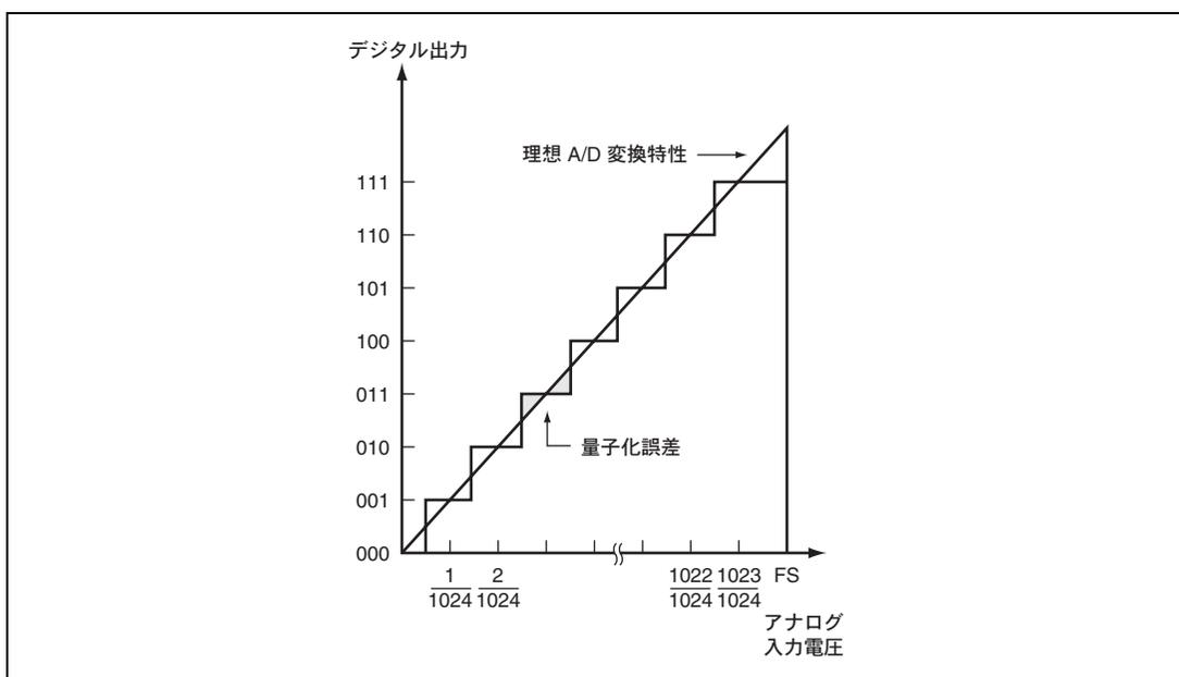
図 16.4 A/D 変換精度の定義
