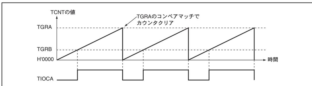
図 10.21 PWMモードの動作例 (1)
