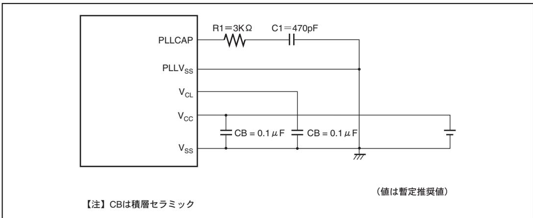
図 19.7 PLL 回路の外付け推奨回路
