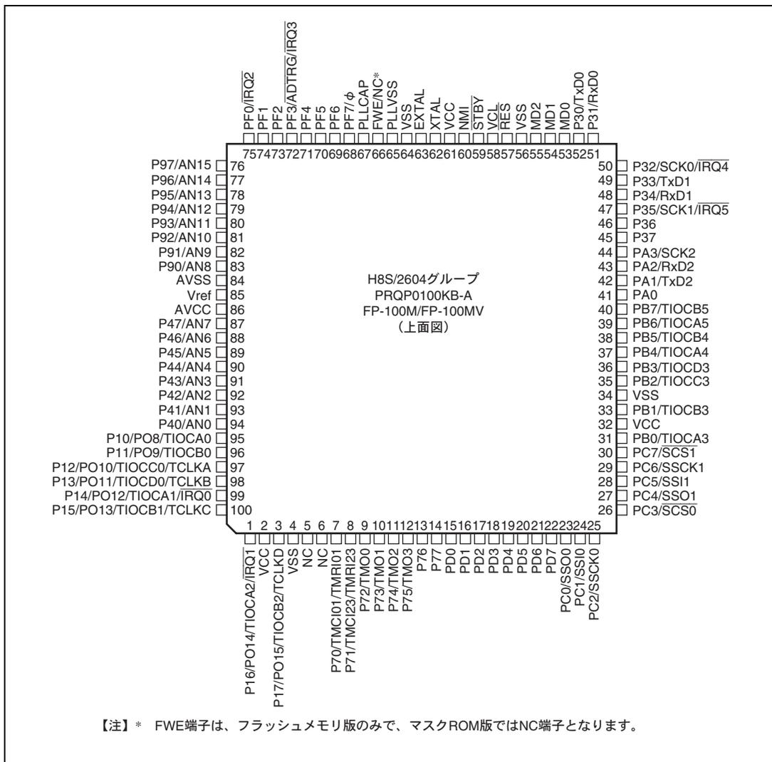
図 1.2 ピン配置図
