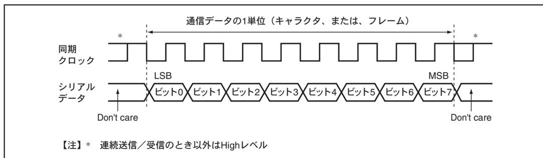
図 14.14 クロック同期式通信のデータフォーマット (LSB フェーストの場合)
