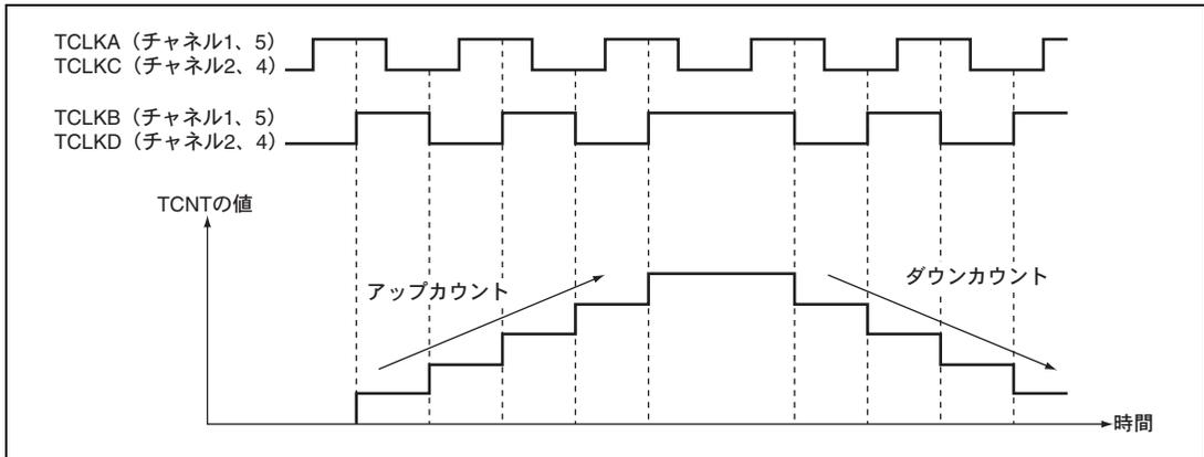
図 10.28 位相計数モード 4 の動作例
