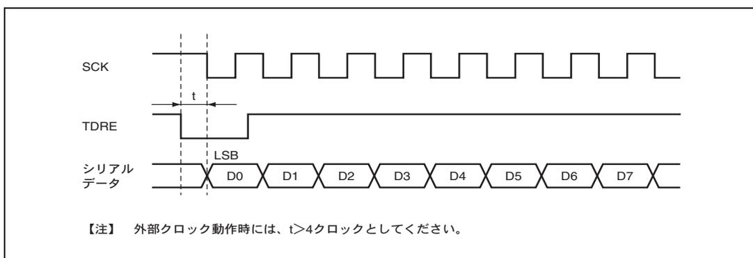
図 14.33 DTC によるクロック同期式送信時の例
