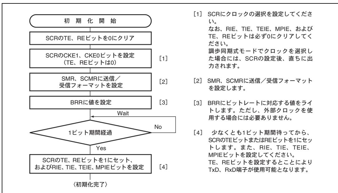
図 14.5 SCIの初期化フローチャートの例
