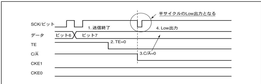
図 14.38 SCK 端子からポート端子へ切り替えるときの動作
