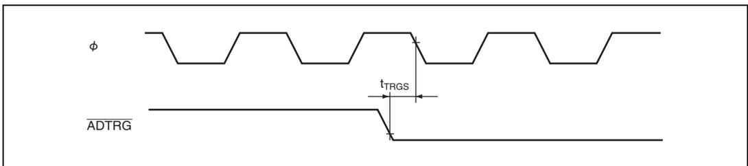
図 22.12 A/D 変換器外部トリガ入カタイミング
