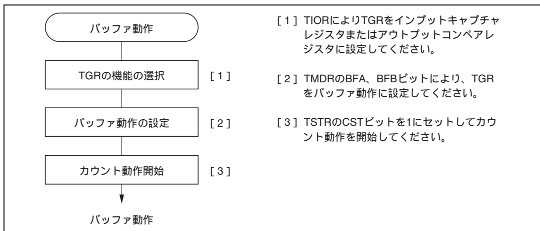
図 9.18 バッファ動作の設定手順例
