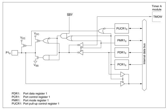
Figure C.1 (d) Port 1 Block Diagram (Pin P1<sub>0</sub>)
