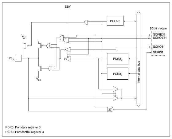
Figure C.2 (d) Port 3 Block Diagram (Pin P3<sub>3</sub>)
