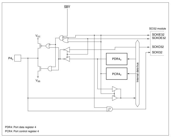
Figure C.3 (d) Port 4 Block Diagram (Pin P4<sub>0</sub>)
