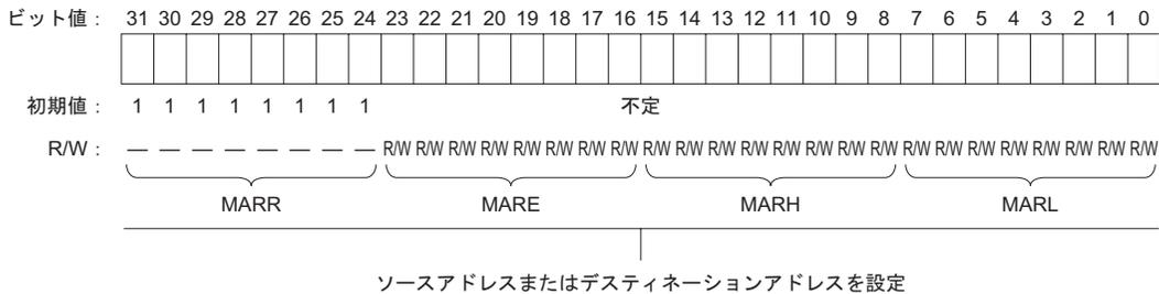
MAR がソースアドレスレジスタとして機能するか、デスティネーションアドレスレジスタとして機能するかは、起動要因によって自動的に決定されます。起動要因が SCI チャンネル 0 の受信完了割り込み、および A/D 変換器の変換終了割り込みの場合はデスティネーションアドレスレジスタとして、それ以外の場合にはソースアドレスレジスタとして機能します。
