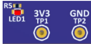
図 8 本評価キットボードのテストポイント TP1、TP2、および LED1
