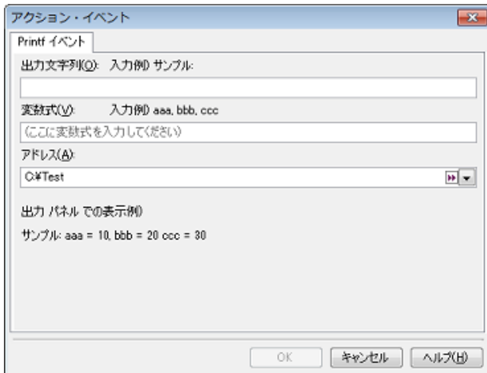
図 2.96 Printf イベントを設定する（アクション・イベント ダイアログ：[Printf イベント] タブ）
