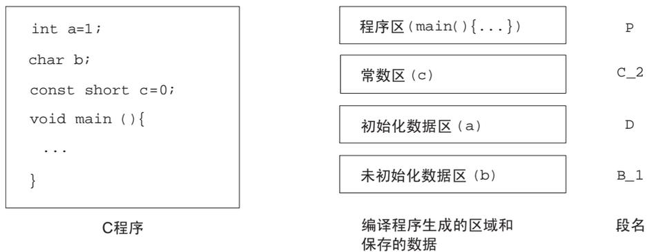
例 2. 用程序例子表示 C++ 程序和编译程序生成段的对应。
