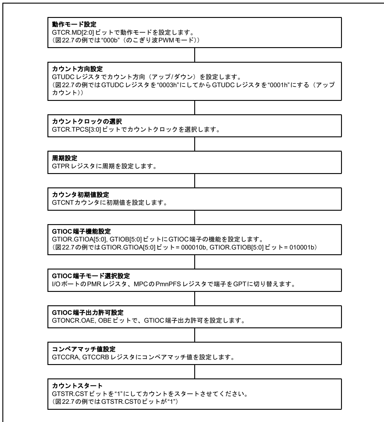
図 22.8 Low 出力 /High 出力動作設定例
