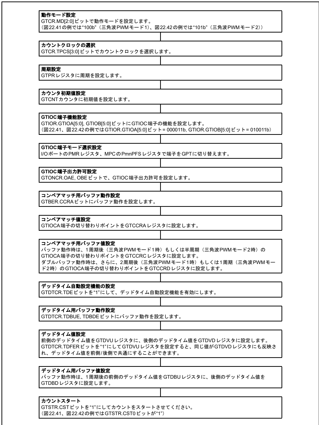
図 22.44 デッドタイム自動設定機能の設定例 (三角波 PWM モード 1/2 時)
