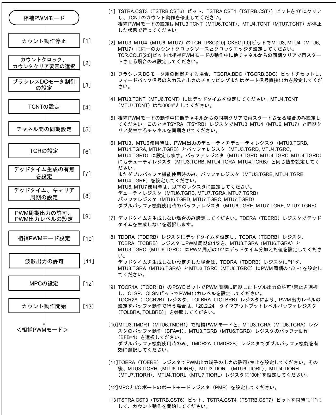
図 20.47 相補 PWM モードの設定手順例
