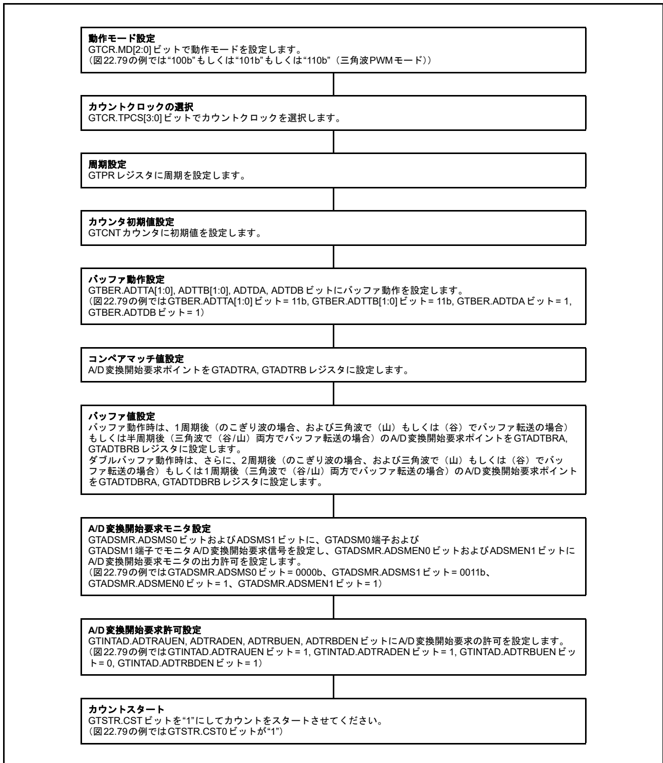
図 22.80 A/D 変換開始要求タイミング動作設定例
