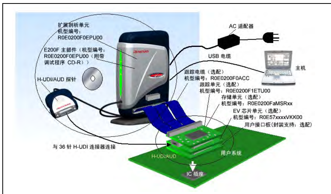
图 1.1 使用仿真器的系统配置
