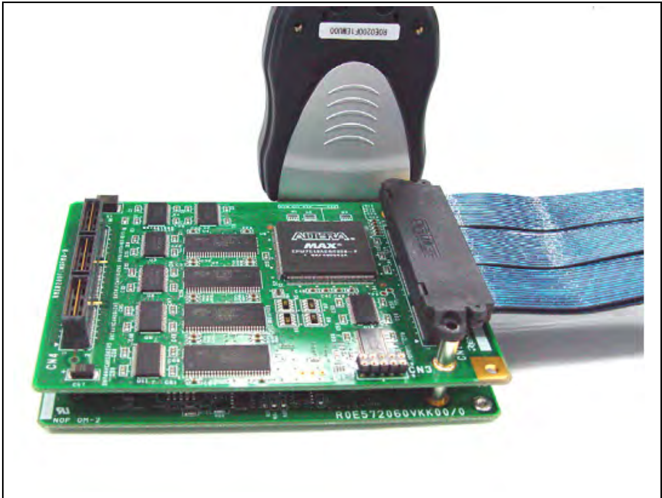
图 2.16 连接仿真存储器单元、EV 芯片单元和跟踪电缆
