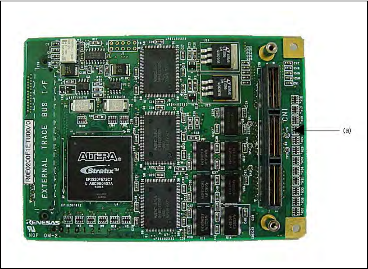
图 1.12 外部总线跟踪单元（可选）顶视图
