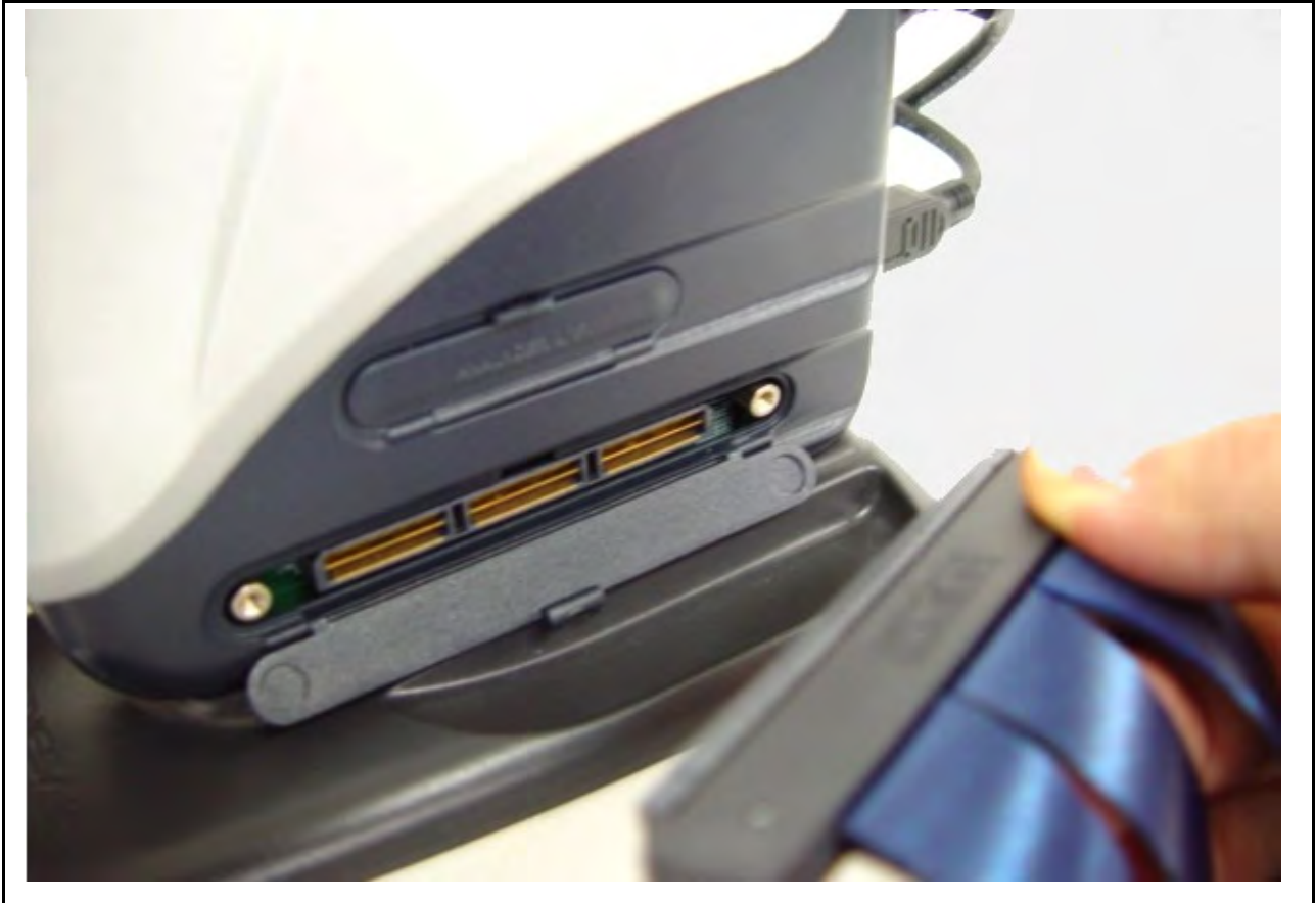
图 2.11 使用 EV 芯片单元时，将跟踪电缆连接至 E200F
