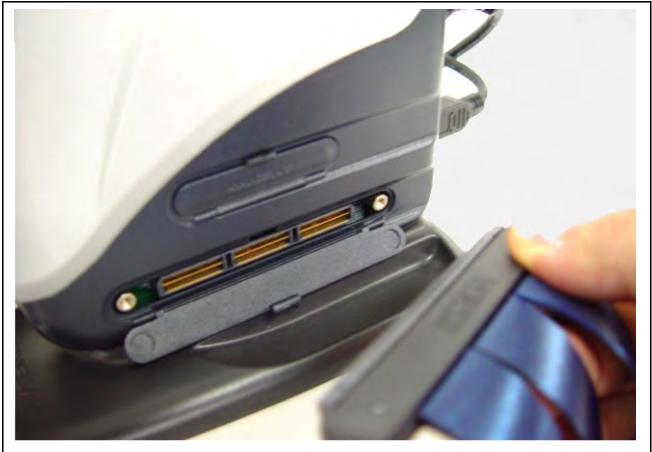
图 2.5 将跟踪电缆连接至 E200F
