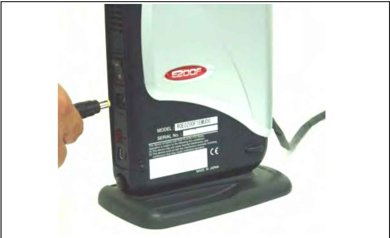
图 2.25 将 AC 适配器连接至主部件壳体
