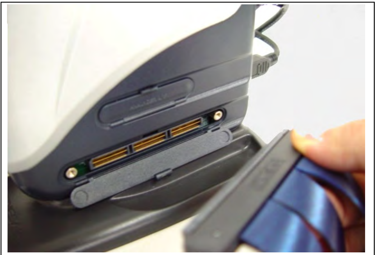
图 2.2 将跟踪电缆连接至 E200F
