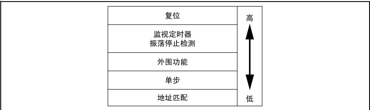
图 11.8 硬件中断的中断优先权
