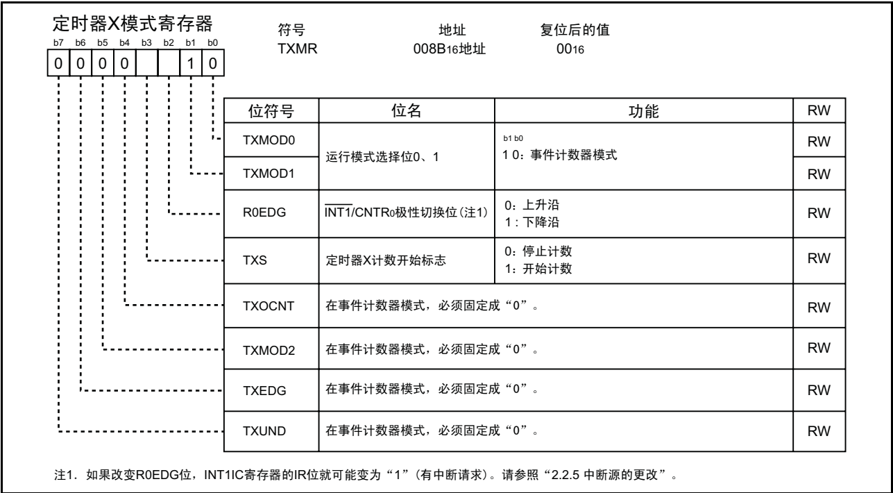
图 13.6 事件计数器模式时的 TXMR 寄存器
