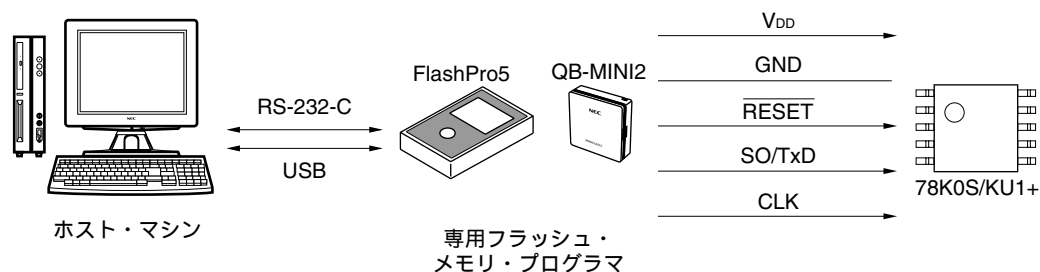
図16-2 フラッシュ・メモリにプログラムを書き込むための環境 (FlashPro5/QB-MINI2)
